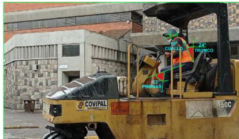
Figura 35-4: Obtención de ángulos articulares del operador del rodillo neumático Grupo A
