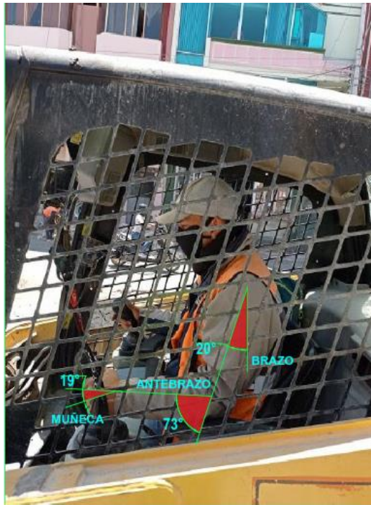
Figura 24-4: Obtención de ángulos articulares del operador de la mini cargadora frontal Grupo B
