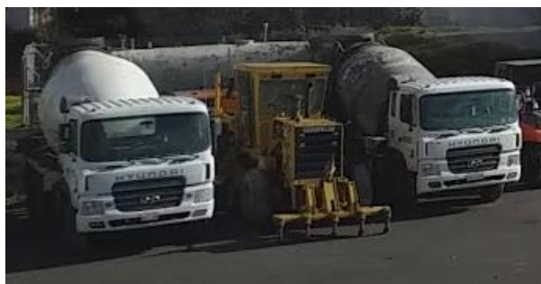
Figura 7-4: Camión mixer de hormigón
