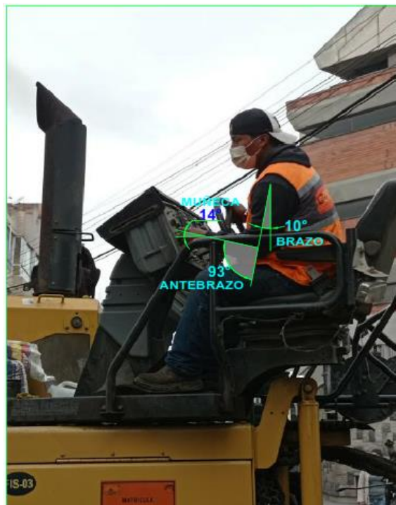
Figura 32-4: Obtención de ángulos articulares del operador de la extendidora de asfalto Finisher Grupo B
