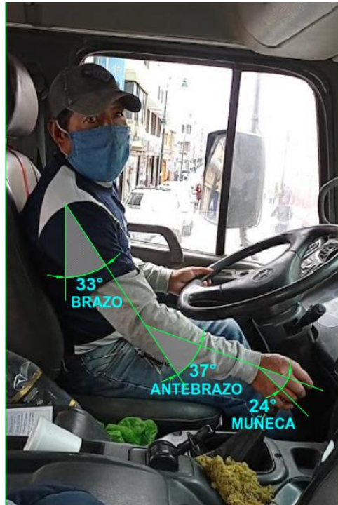
Figura 26-4: Obtención de ángulos articulares del chofer del camión mixer de hormigón Grupo B
