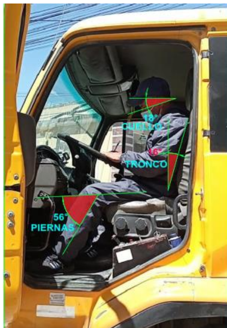
Figura 29-4: Obtención de ángulos articulares del chofer del tanquero de imprimación Grupo A
