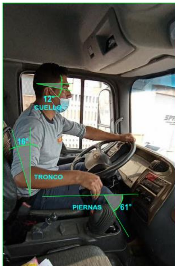
Figura 27-4: Obtención de ángulos articulares del chofer del tanquero de agua Grupo A
