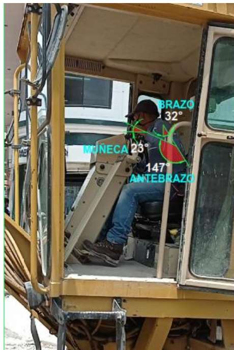
Figura 20-4: Obtención de ángulos articulares del operador de la motoniveladora Grupo B
