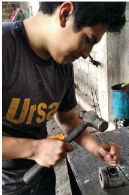
**Figura 1-3.** Realizar golpes con el lado de la cabeza del martillo
