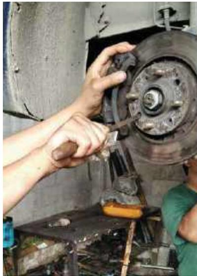
**Figura 6-3.** Hacer palanca con la lima
