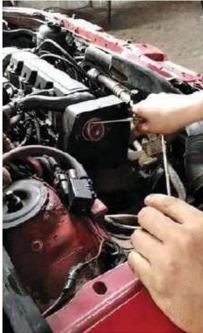
**Figura 11-3.** Hacer palanca con el destornillador
