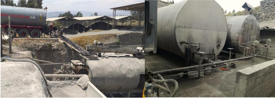
**Figura 5-3:** Zona de descarga y almacenamiento de AC-20
