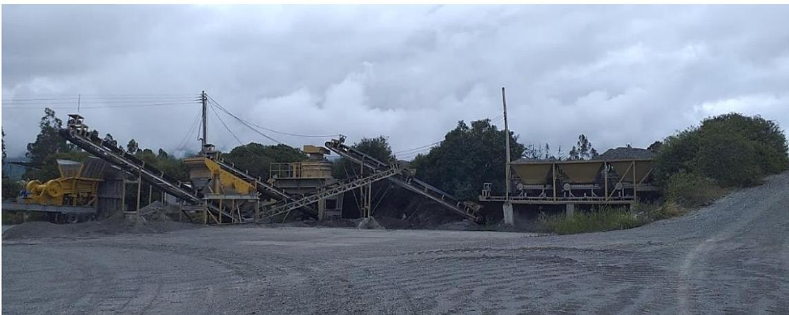
**Figura 2-3:** Planta de trituración secundaria (BCI)
