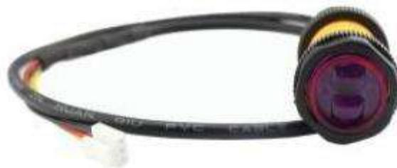
**Figura 14-2:** Sensor infrarrojo modelo E18-D80NK.
