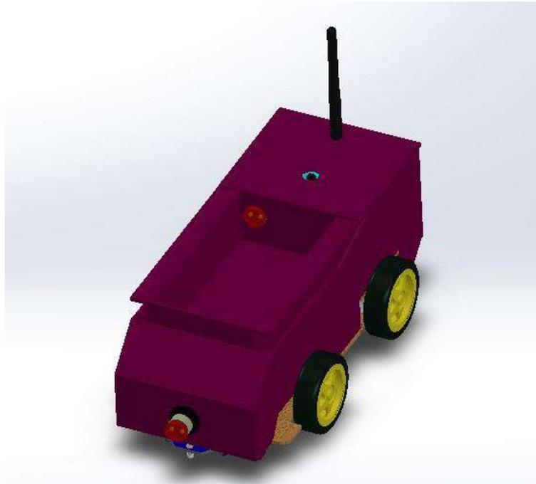
**Figura 61-3:** Modelo tridimensional del seguidor de línea.
