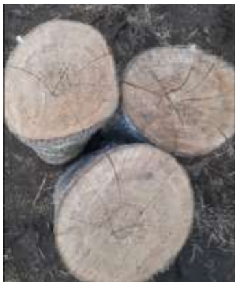
Figura 3-1. Fisuras de trozas. Realizado por: Pardo, D, 2021.
