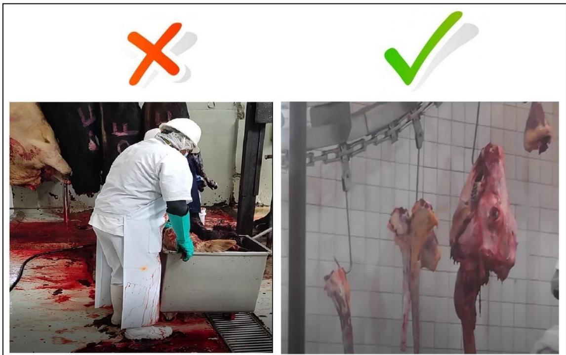
**Figura 4-4:** Comparativa entre el transporte por carro y el de rieles para las extremidades del animal.
