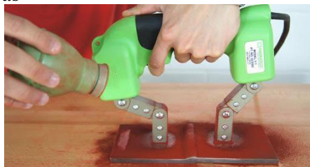
Figura 2- 40: Ensayo de partículas magnéticas Fuente: Llogsa Realizado por: Borja, Darío, 2020.
