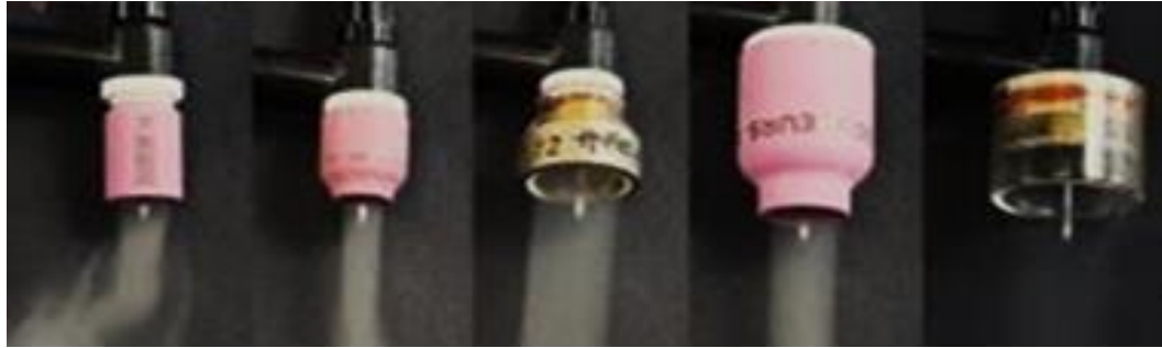
Figura 2- 15: Difusión del gas según el tipo de boquilla
