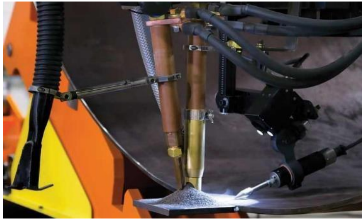
Figura 2- 19: Soldadura de arco sumergido
