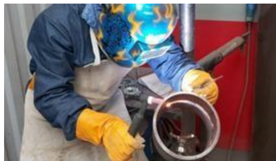
Figura 2- 12: Proceso GTAW en un cupón de tubería
