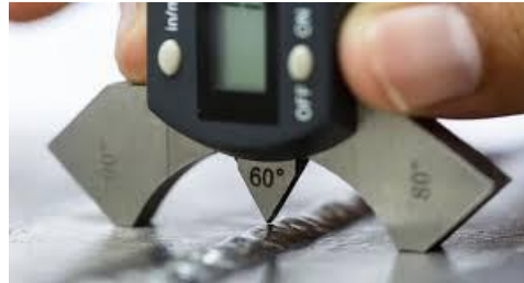
Figura 2- 36: Inspección visual en soldadura Fuente: Ingeniero de caminos Realizado por: Borja, Darío; 2020.
