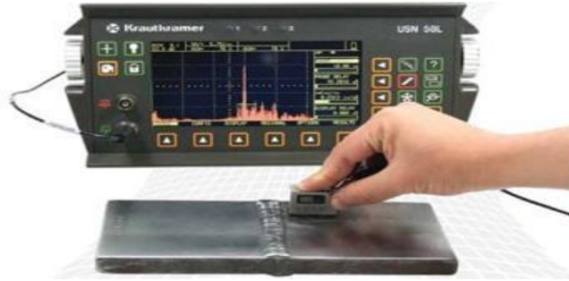
Figura 2- 39: Análisis de un cupón de prueba con ultrasonido Fuente: Monitoreo condición Realizado por: Borja, Darío; 2020.
