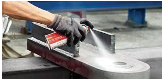
Figura 2- 37: Ensayo de tintas penetrantes Fuente: Asmesol Realizado por: Borja, Darío; 2020.
