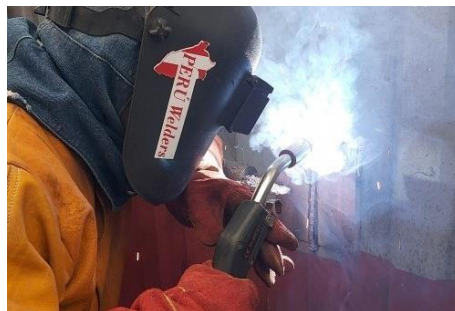
Figura 2- 10: Proceso FCAW en cupón de prueba
