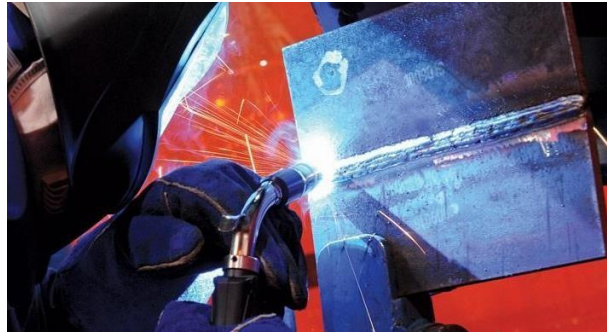
Figura 2- 8: Proceso GMAW en cupón de prueba
