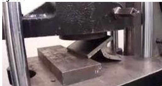
Figura 2- 44: Ensayo de rotura de filete
