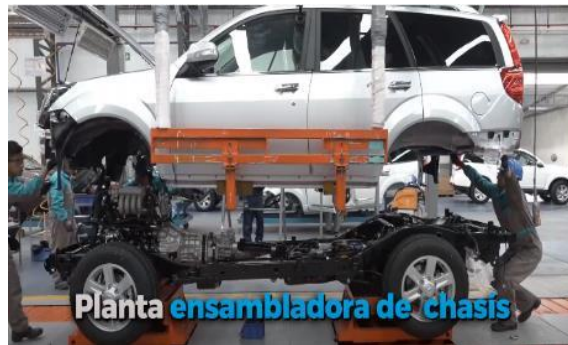
Figura 10-3: Proceso de ensamble de chasis
