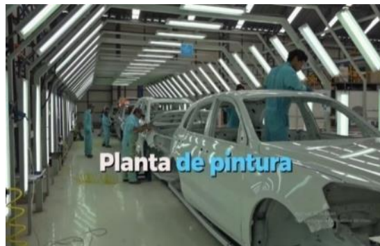
Figura 7-3: Proceso de pintura de carrocerías
