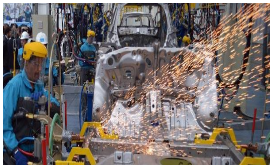
Figura 6-3: Proceso de soldadura de carrocerías
