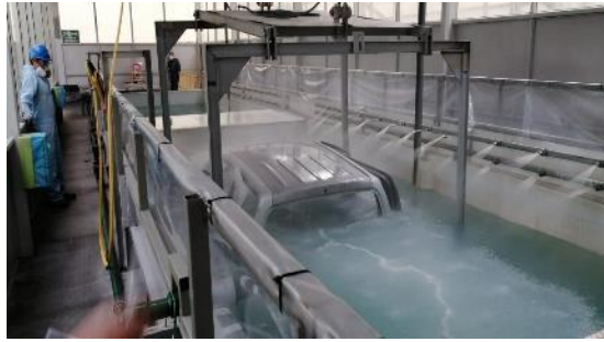
Figura 8-3: Cuba de desengrase del proceso ELPO
