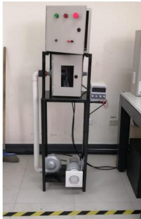
**Figura 12-2.** Diseño final del módulo soplador
