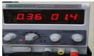
**Figura 1-3.** Fuente de poder con los valores de intensidad y corriente a usar en el experimento
