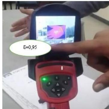
**Figura 7-3.** Configuración del ajuste de la emisividad en la cámara termográfica SATIR
