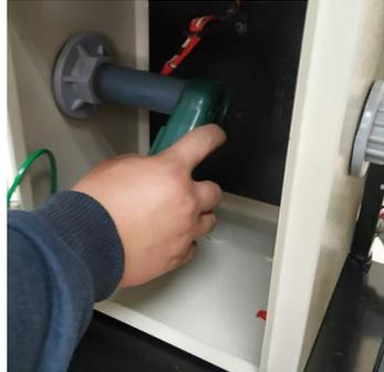
**Figura 11-3.** Medición de la velocidad del viento generado por el módulo soplador
