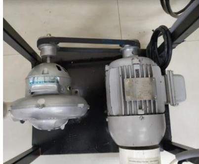
**Figura 4-2.** Ubicación del motor soplador en la base
