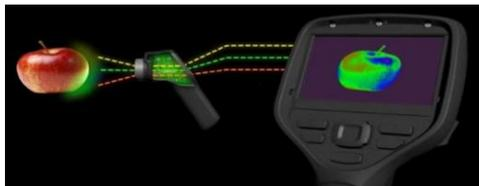
**Figura 17-1.** Energía emitida por el objeto y captada por la cámara termográfica
