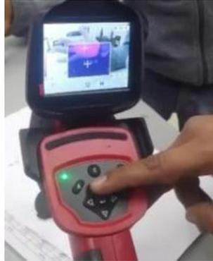
**Figura 8-3.** Selección del punto en el termograma de la cámara termográfica SATIR
