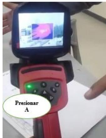
**Figura 6-3.** Ajuste del Spam térmico de la cámara
