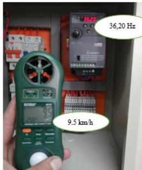
**Figura 13-3:** Relación entre frecuencia y velocidad de viento
