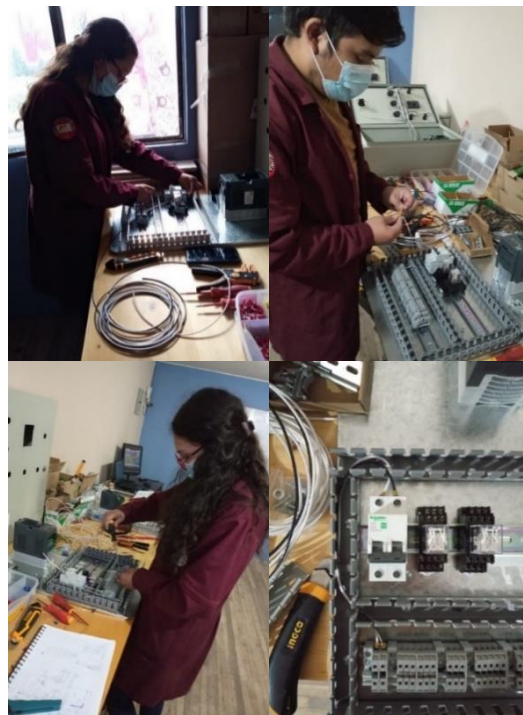
Figura 17-3: Conexión, ajuste y etiquetado del circuito
