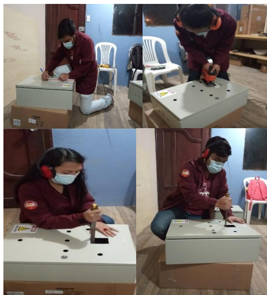
Figura 6-3: Bosquejo, corte y limado de la pantalla del variador.
