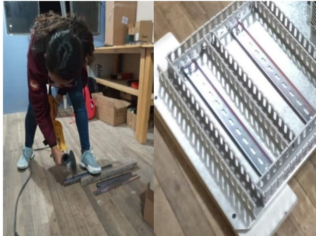
Figura 9-3: Corte y colocación del Riel DIN.
