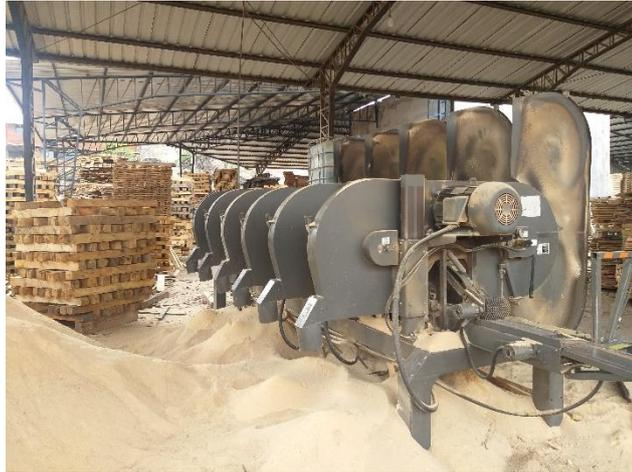
**Figura 5-3:** Cortadora de cinta de 6 cabezales
