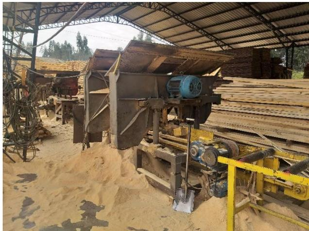
**Figura 3-3:** Cortadora de cinta de 2 cabezales
