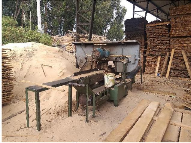
**Figura 2-3:** Cortadora de cinta de 1 cabezal
