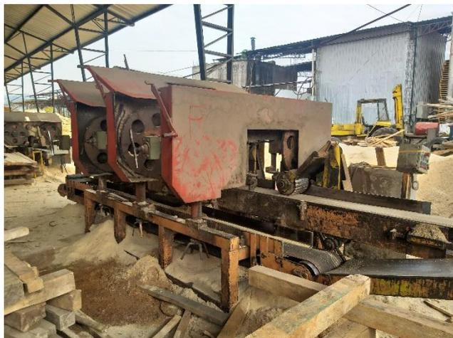
**Figura 4-3:** Cortadora de cinta de 3 cabezales
