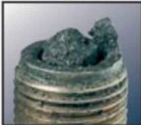
Figura 17-2: Fusión de los electrodos. Fuente: (Belló, 2017)
