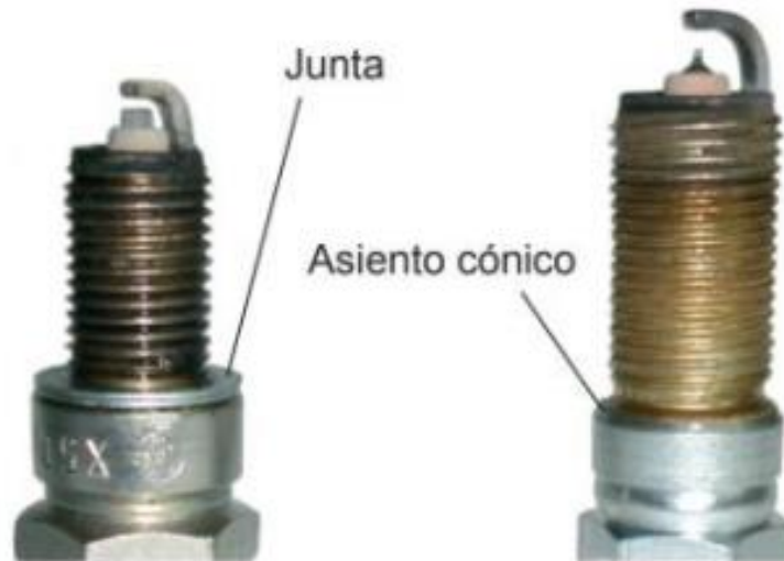
Figura 8-2: Tipos de asientos de bujía. Fuente: (Belló, 2017)
