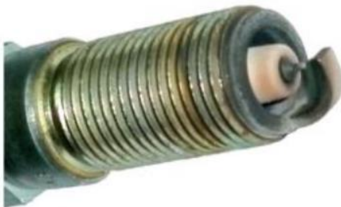
Figura 13-2: Aspecto ideal de una bujía. Fuente: (Belló, 2017)
