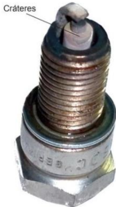
Figura 16-2: Cráteres por detonación. Fuente: (Belló, 2017)
