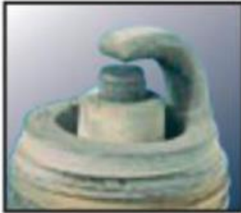
Figura 18-2: Depósitos por aditivos. Fuente: (Belló, 2017)
