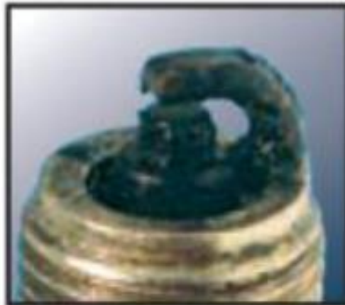
Figura 15-2: Bujía engrasada. Fuente: (Belló, 2017)
