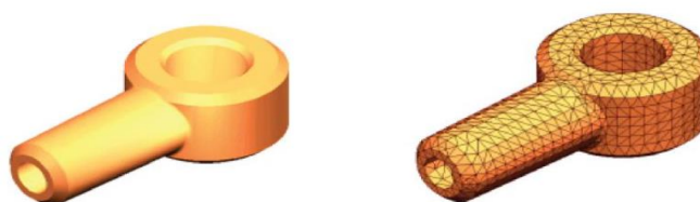
Figura 8-1: Modelo CAD de una pieza y modelo dividido en elementos finitos
