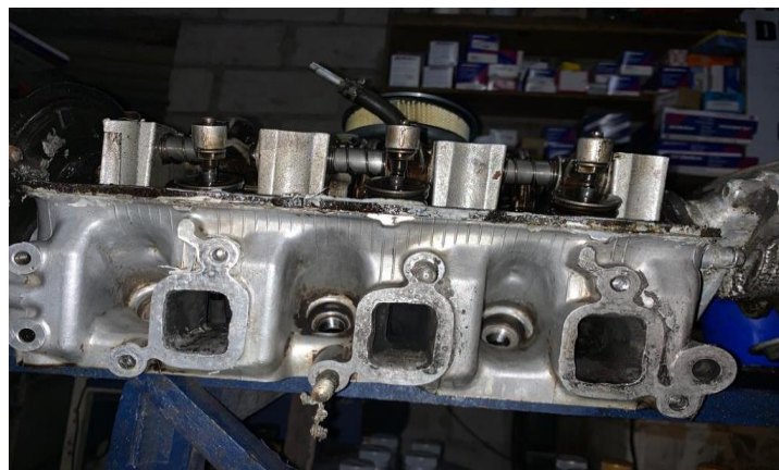
Figura 19-3: Remoción del material en las toberas de escape Realizado por: (SALAZAR, D & BARROS, B, 2021)
