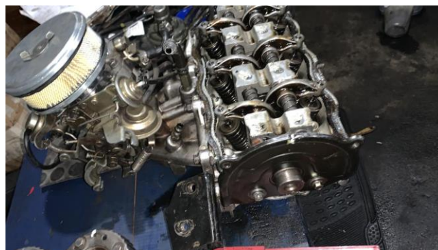
Figura 30-3: Montaje de componentes de la culata.
