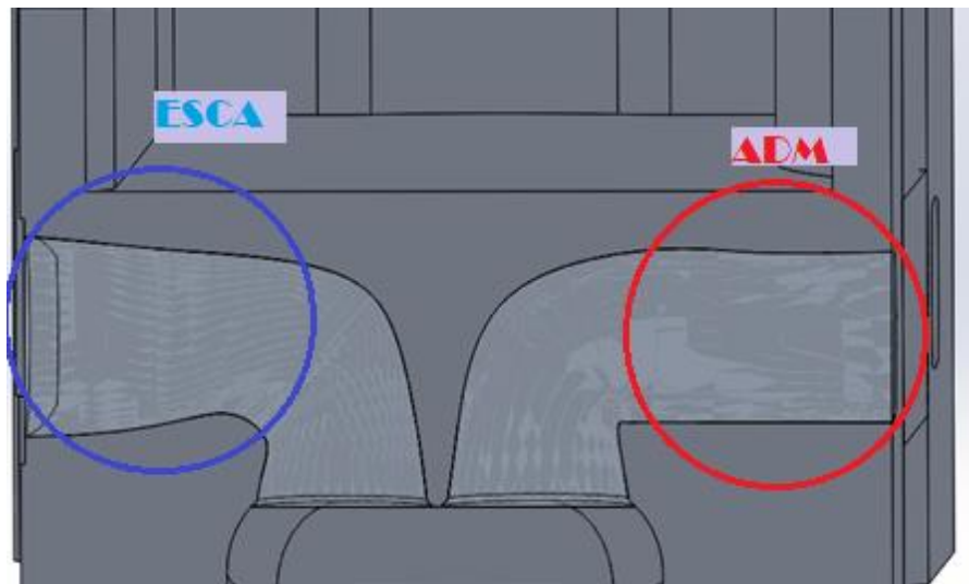
Figura 6-3: Sección transversal de conductor de admisión y escape Realizado por: (SALAZAR, D & BARROS, B, 2021)
