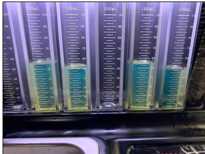
Figura 24-3: Medición de volúmenes de las toberas trucadas. Realizado por: (SALAZAR, D & BARROS, B, 2021)
