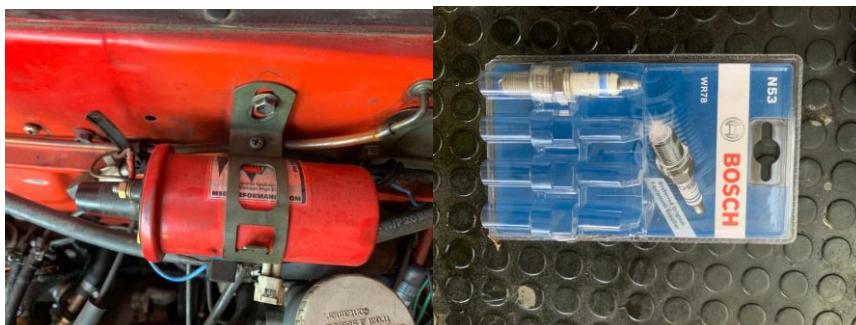
Figura 41-3: Bobina y bujías Realizado por: (SALAZAR, D & BARROS, B, 2021)
