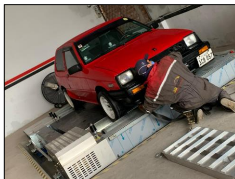
Figura 2-3: Anclaje de las correas de seguridad. Realizado por: (SALAZAR, D & BARROS, B, 2021)
