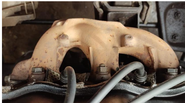
Figura 10-3: Extracción del múltiple de escape Realizado por: (SALAZAR, D & BARROS, B, 2021)
