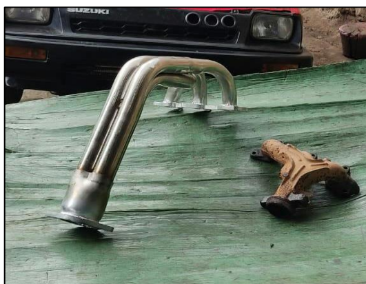
Figura 28-3: Fabricación del header Realizado por: (SALAZAR, D & BARROS, B, 2021)
