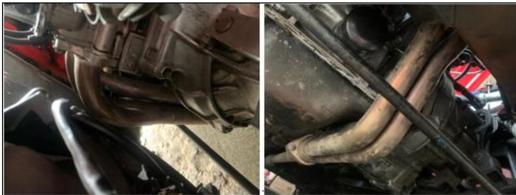
Figura 38-3: Montaje del header.
