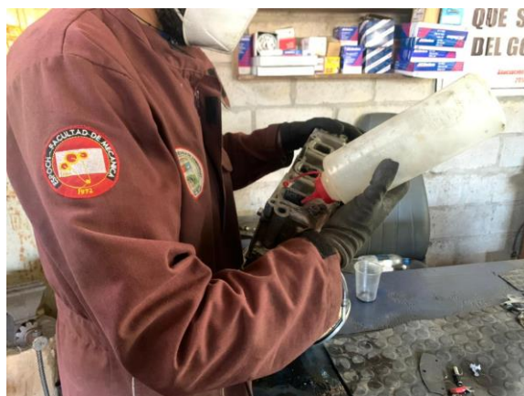
Figura 16-3: Medición de los volúmenes
