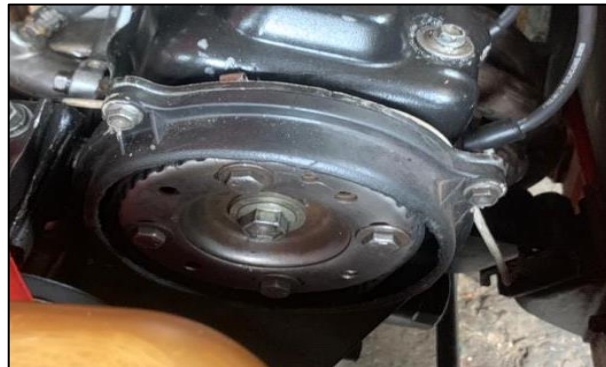
Figura 35-3: Montaje de la banda y templador Realizado por: (SALAZAR, D & BARROS, B, 2021)
