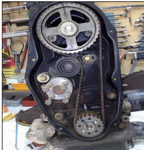
Figura 8-3: Desarmado del templador y de la polea Realizado por: (SALAZAR, D & BARROS, B, 2021)
