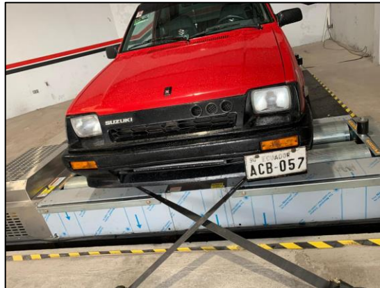
Figura 3-2: Pruebas del dinamómetro. Realizado por: (SALAZAR, D & BARROS, B, 2021)
