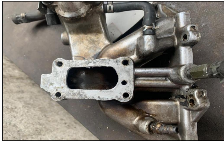
Figura 9-3: Extracción del múltiple de admisión. Realizado por: (SALAZAR, D & BARROS, B, 2021)
