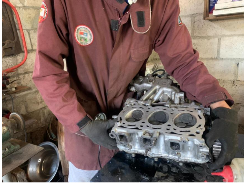
Figura 11-3: Extracción del cabezote. Realizado por: (SALAZAR, D & BARROS, B, 2021)
