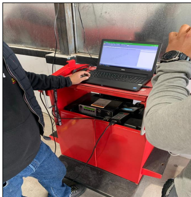
Figura 4-3: Obtención de datos del dinamómetro Realizado por: (SALAZAR, D & BARROS, B, 2021)
