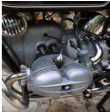
Figura 7-1: Motor de una motocicleta con refrigeración directa de aire
