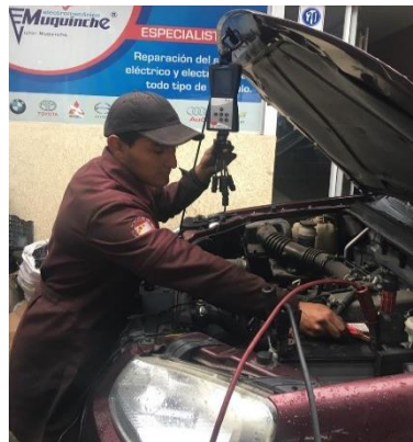
Figura 34-2: Conexión a batería de equipo MGT-300 EVO Realizado por: Lesano, Stalin, 2021.
