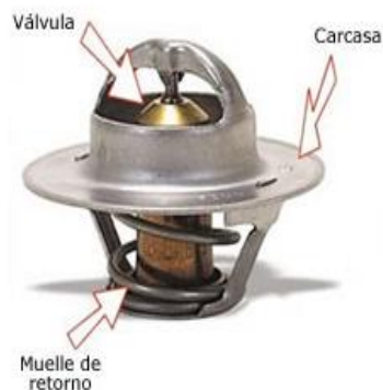
Figura 16-1: Termostato de cera Fuente: (Granel, A, 2020)
