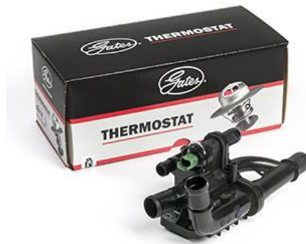
Figura 17-1: Termostatos marca Gate controlado electrónicamente
