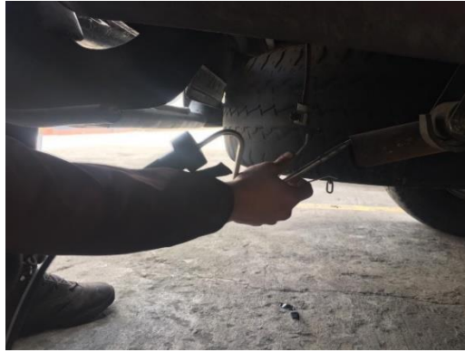
Figura 33-2: Colocación de la sonda en el tubo de escape Realizado por: Lesano, Stalin, 2021.
