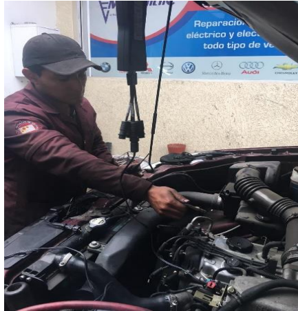
Figura 36-2: Instalación de la sonda de golpeo para RPM del equipo MGT-300 EVO Realizado por: Lesano, Stalin, 2021.
