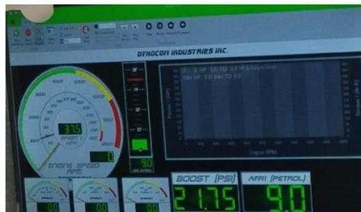
**Figura 55-3:** AFR medido en el dinamómetro a 1000 RPM con sistema carburado
