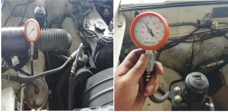
**Figura 53-3:** Medición de compresión en cada uno de los cilindros del motor
