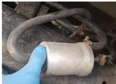
**Figura 18-3:** Instalación de filtro regulador
