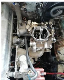
**Figura 6-3:** Desmontaje del múltiple de admisión del sistema carburador
