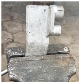
**Figura 13-3:** Base de aluminio para el sensor CKP
