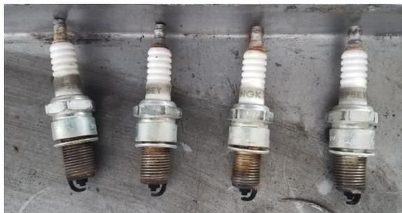
**Figura 8-3:** Desmontaje y estado de bujías en sistema por carburador
