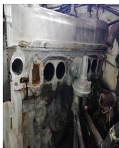
**Figura 7-3:** Conductos de entrada de la mezcla hacia los cilindros
