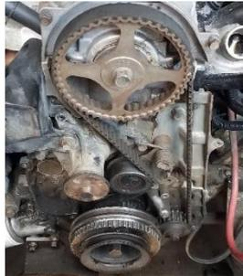
**Figura 12-3:** Rueda fónica instalada en el motor
