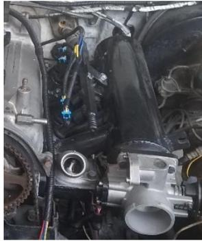
**Figura 16-3:** Instalación del múltiple de admisión junto con el riel de inyección
