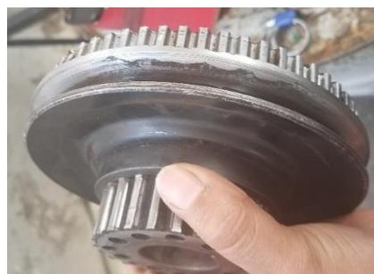
**Figura 11-3:** Acople de rueda fónica con la polea del cigüeñal
