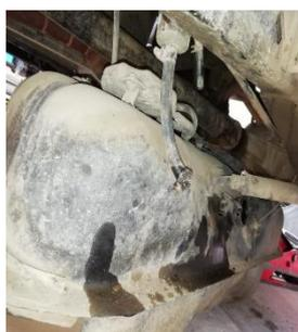
**Figura 9-3:** Desmontaje y estado del depósito de combustible
