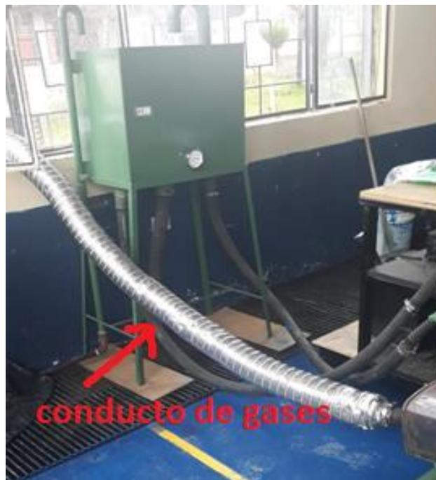
**Figura 4-4:** Conducto de emisión de gases.
