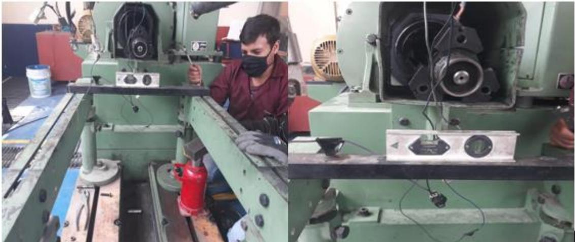
**Figura 12-3:** Verificar nivelación de bancada
