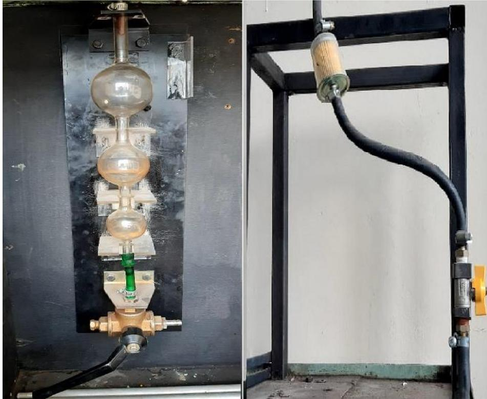
**Figura 7-3:** Estado original del sistema de medición de combustible
