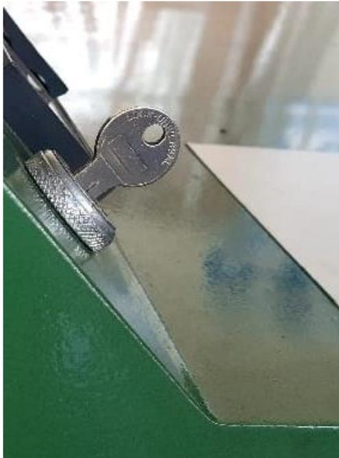
**Figura 10-4:** Switch del motor.
