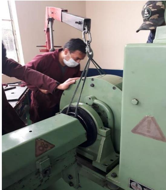
**Figura 16-3:** Retirando el generador de carga del dinamómetro
