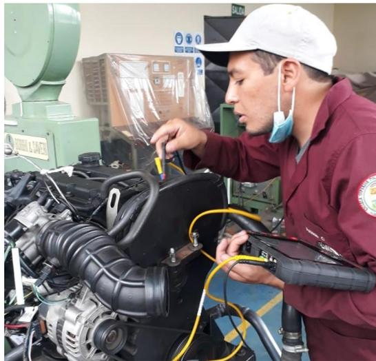
**Figura 24-3:** Ubicando pines del sensor con ayuda del Osciloscopio
