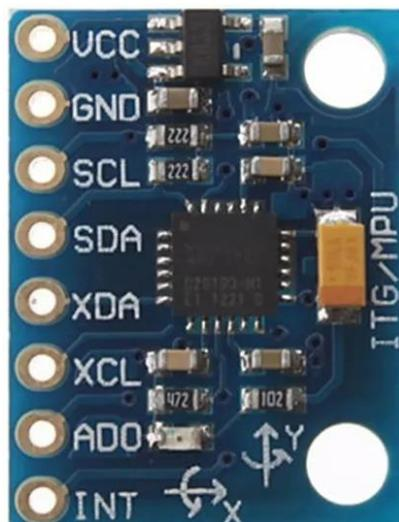
**Figura 27-3:** Sensor de Giro (Giroscopio)
