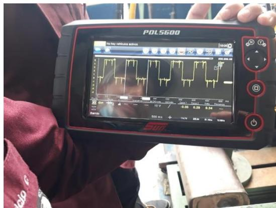
**Figura 25-3:** Señal de sensor CMP
