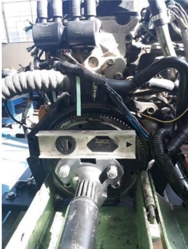
**Figura 1-4:** Verificando que el motor este alineado con el cardan del dinamómetro
