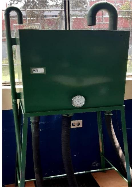
**Figura 3-4:** Reservorio de refrigeración del motor.
