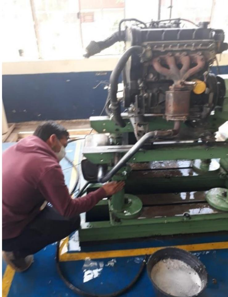
**Figura 18-3:** Desengrase de partes del dinamómetro
