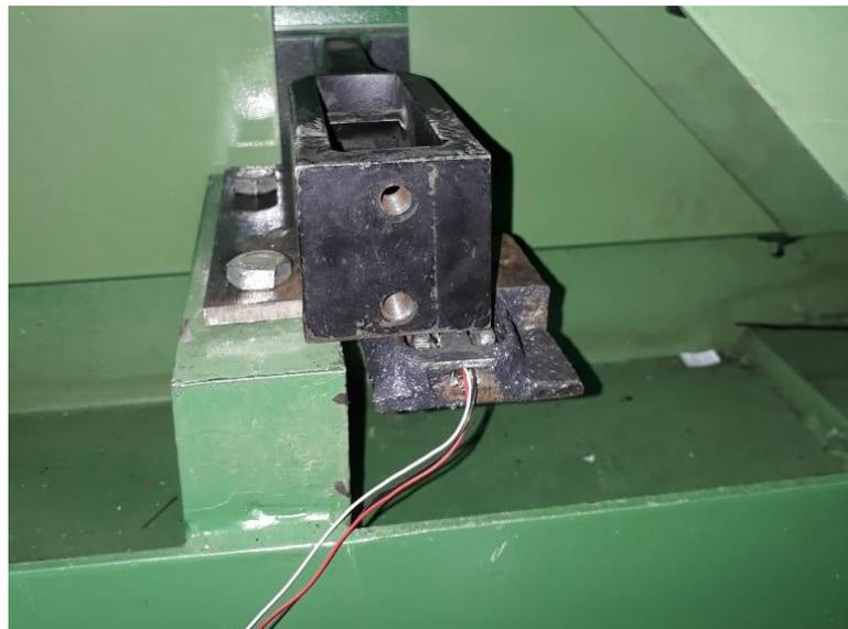
**Figura 31-3:** Ubicación de celda de carga 50 kg
