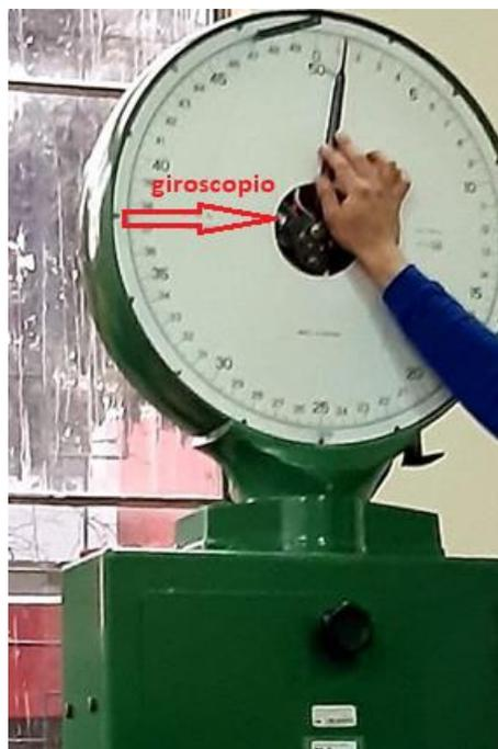
**Figura 28-3.** Ubicación del sensor MPU6050
