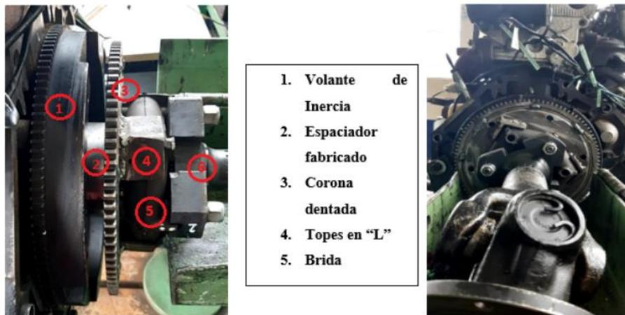
**Figura 15-3:** Vista lateral y frontal de acople
