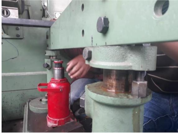
**Figura 11-3.** Uso del gato hidráulico para regular bancada
