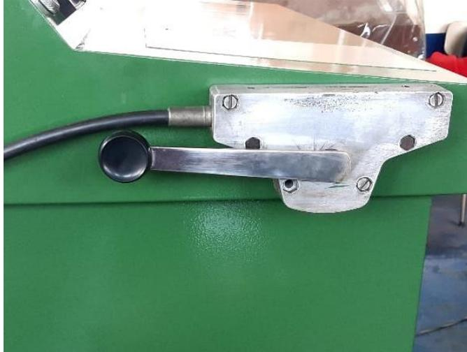
**Figura 13-4:** Posición del acelerador de motor
