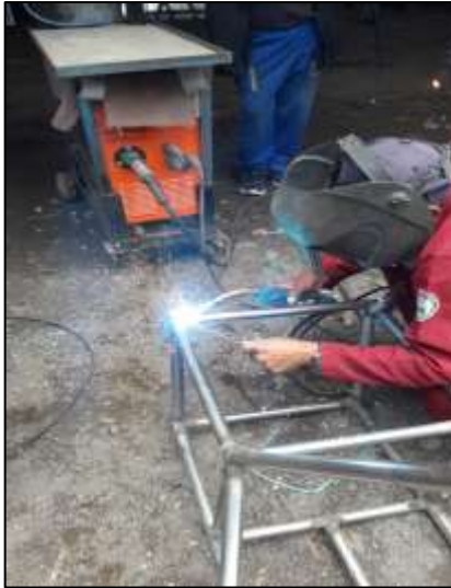
Figura 59-3: Soldadura de la estructura del chasis.
