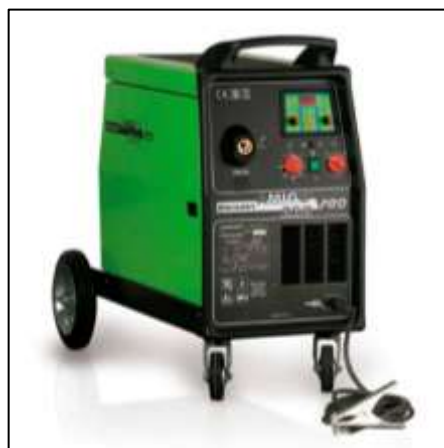
Figura 25-3: Equipo de suelda MIG Indura Amigo 263
