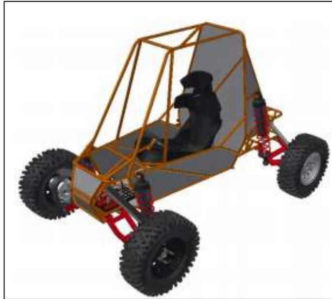
Figura 30-4: Modelo de diseño del chasis tubular
