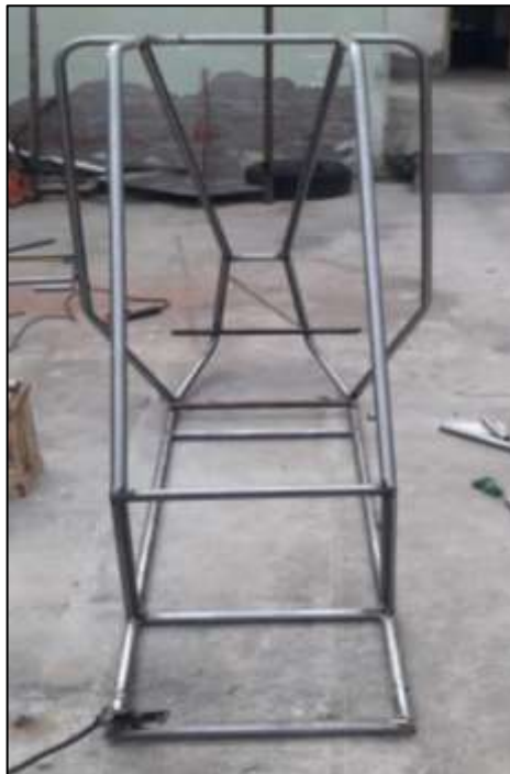
Figura 51-3: Instalación de los tubos de la parte superior
