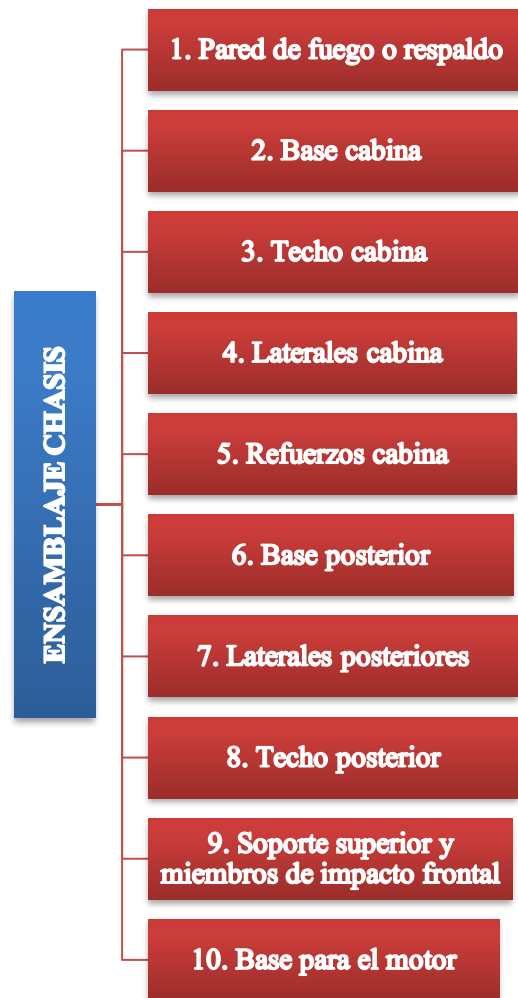
Gráfico 12-3: Secuencia de ensamblaje de miembros estructurales
