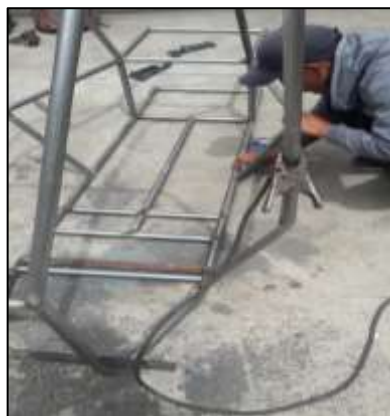
Figura 54-3: Ubicación de los soportes laterales del chasis
