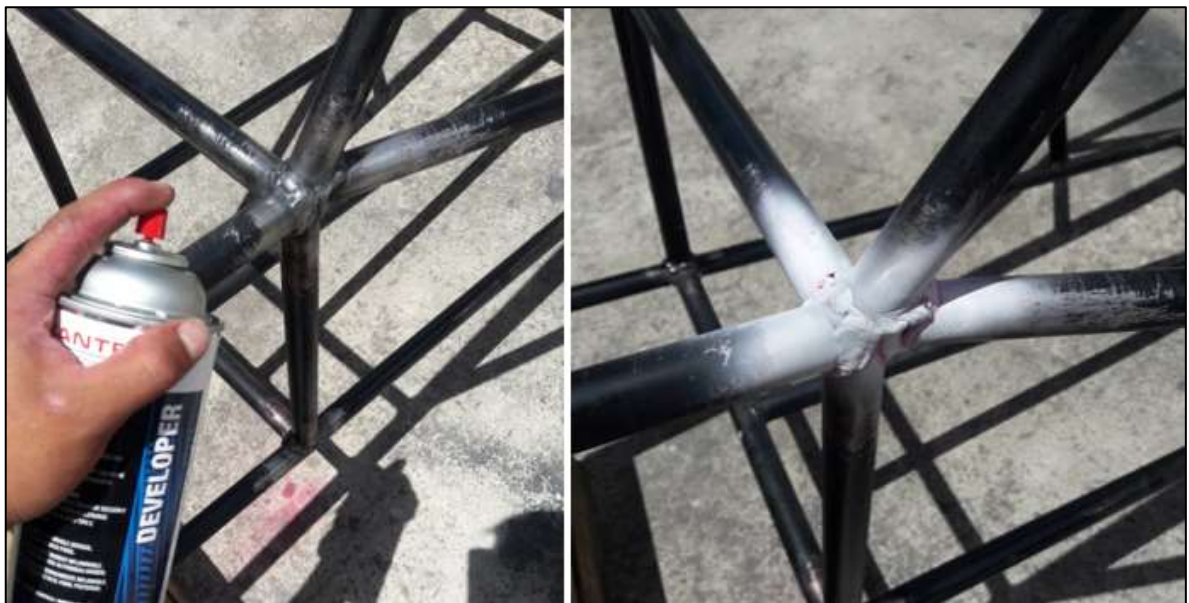
Figura 72-3: Aplicación del líquido revelador
