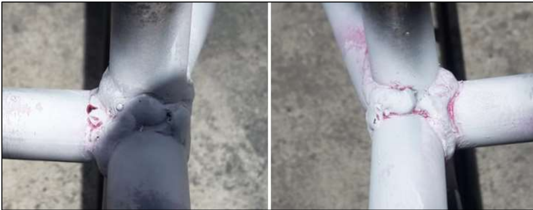
Figura 73-3: Reacción química del líquido revelador
