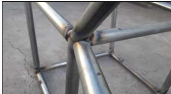
Figura 60-3: Uniones soldadas de miembros estructurales
