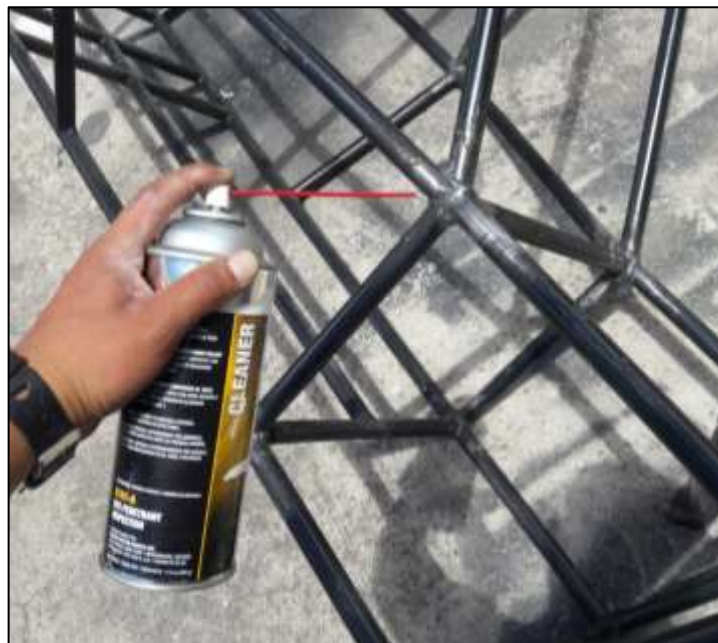
Figura 69-3: Aplicaciones del líquido removedor
