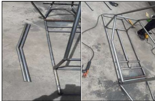
Figura 53-3: Montaje de tubos de los laterales del chasis
