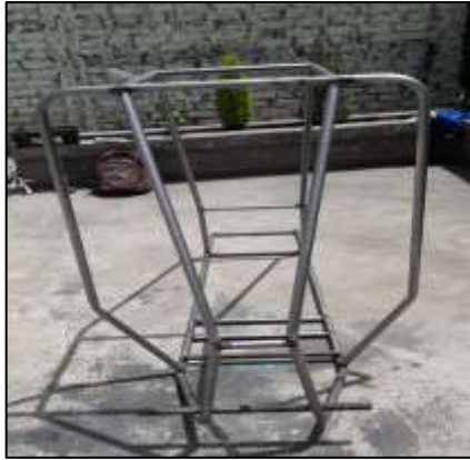
Figura 52-3: Instalación de los tubos de la base del chasis
