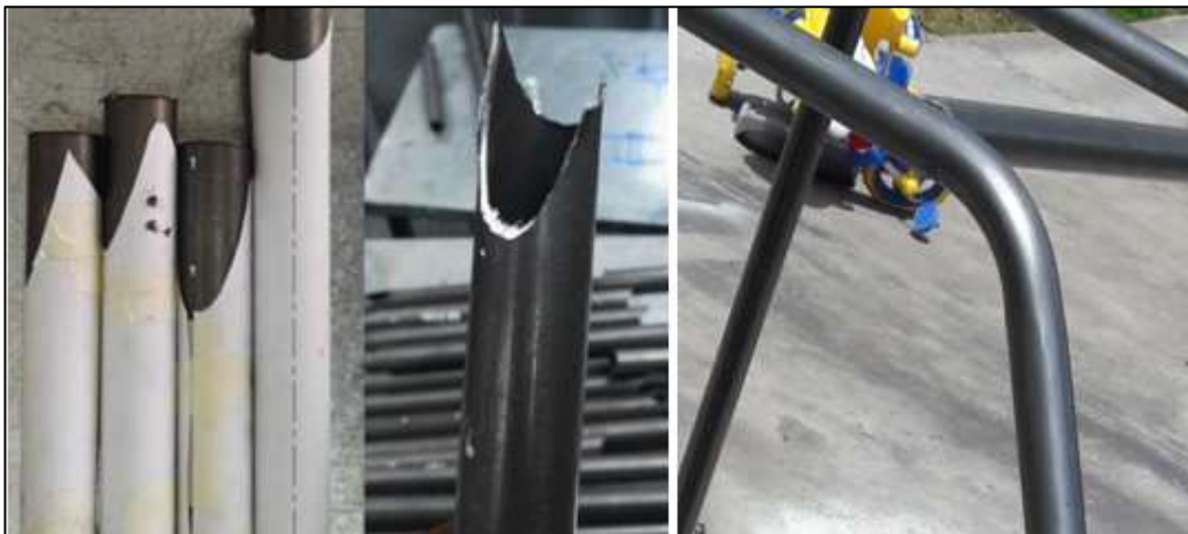
Figura 25-4: cortes y curvaturas de los miembros estructurales
