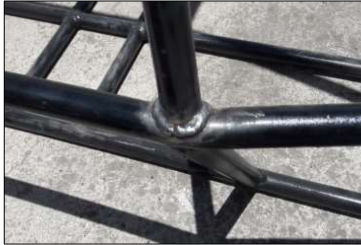
Figura 71-3: Remoción del líquido penetrante
