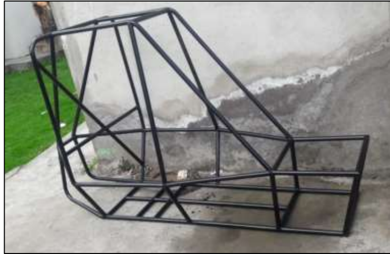
Figura 31-4: Resultado final del chasis tubular
