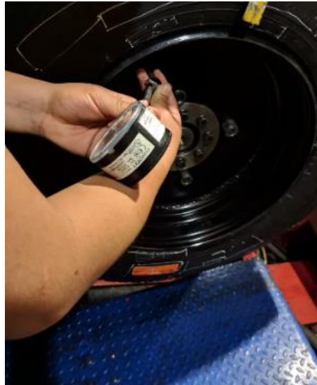
Figura 2-3: Medición de presión de inflado Realizado por: Pérez y Román, 2020
