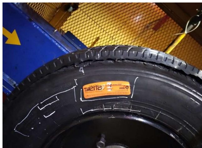
Figura 4-3: Desprendimiento de banda de rodadura Realizado por: Pérez y Román, 2020
