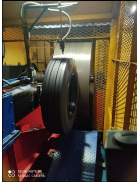
Figura 11-2: Ensayo de aguante Realizado por: Pérez y Román, 2020
