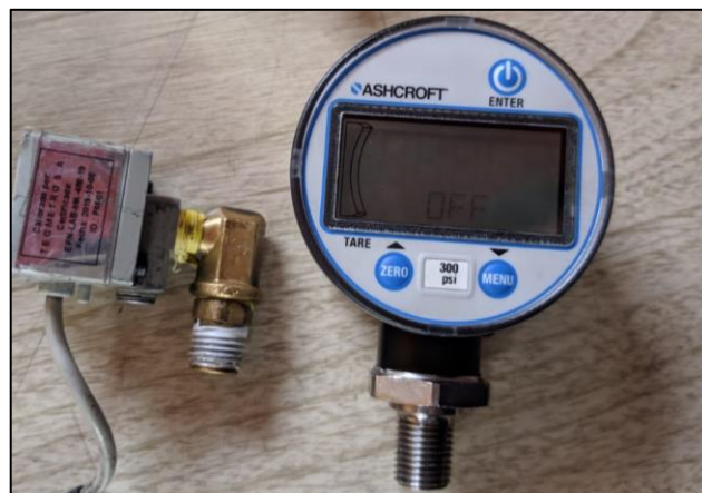
Figura 9-2: Manómetro de presión Realizado por: Pérez y Román, 2020
