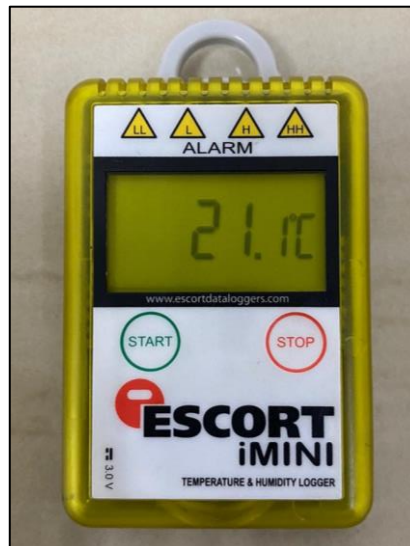
Figura 8-2: Termohigrometro Realizado por: Pérez y Román, 2020
