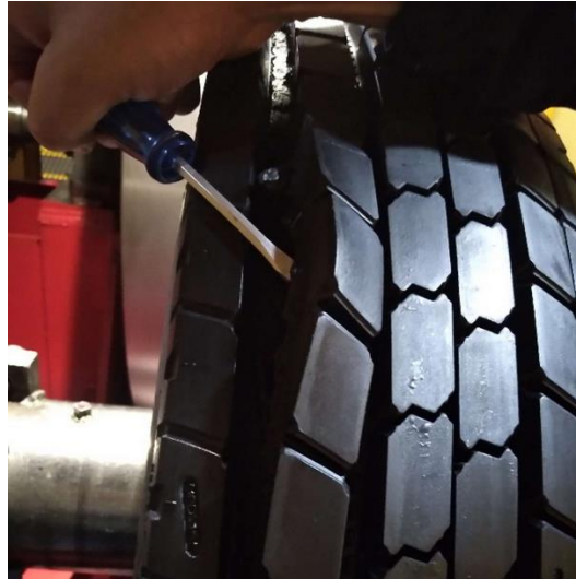
Figura 5-3: Desprendimiento de banda de rodadura Realizado por: Pérez y Román, 2020
