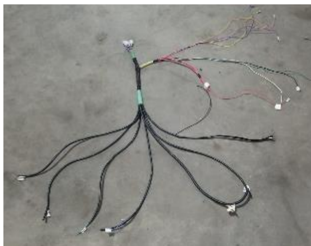
Figura 17-3: Arnés de la unidad de control programable Fuente: Soto Alex, Palacios Paul, 2021
