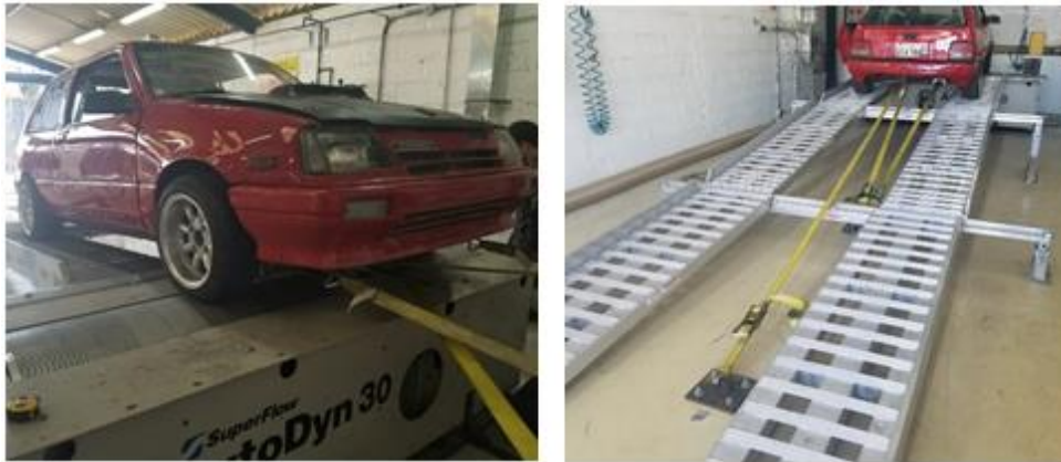
Figura 1-4: Colocación del vehículo y anclaje en el dinamómetro Fuente: Soto Alex, Palacios Paul, 2021
