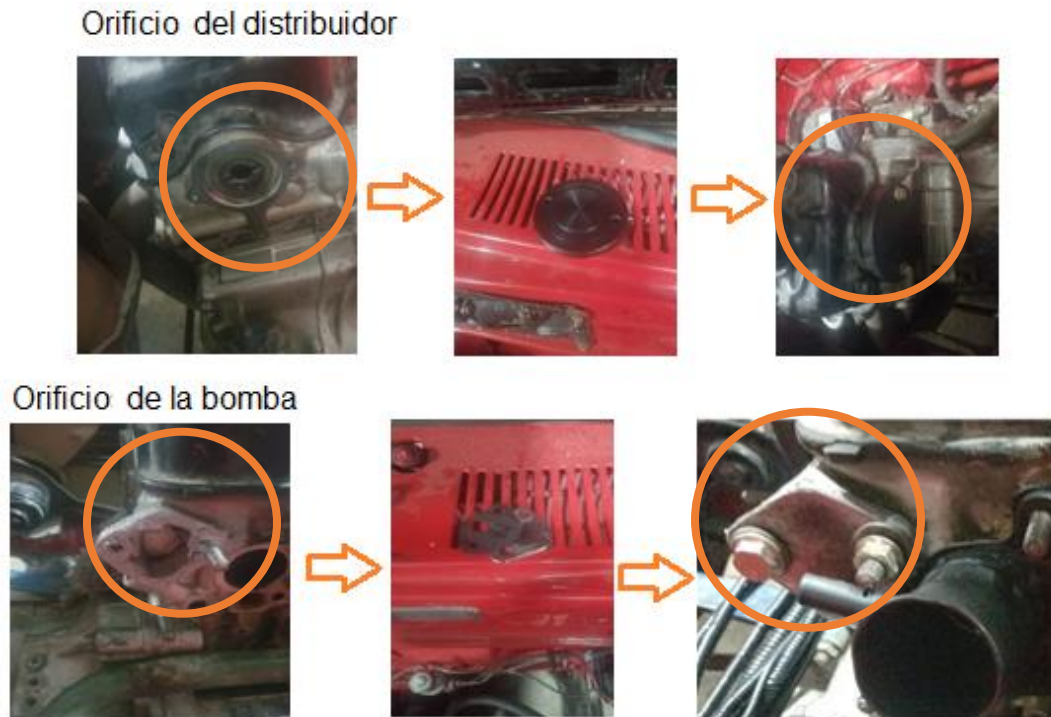
Figura 8-3: Sellado de orificios de la bomba de combustible y distribuidor. Realizado por: Soto Alex, Palacios Paul, 2021
