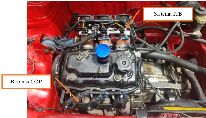
Figura 47-3: Adaptaciones del motor respecto a los sistemas de admisión y encendido Fuente: Soto Alex, Palacios Paul, 2021
