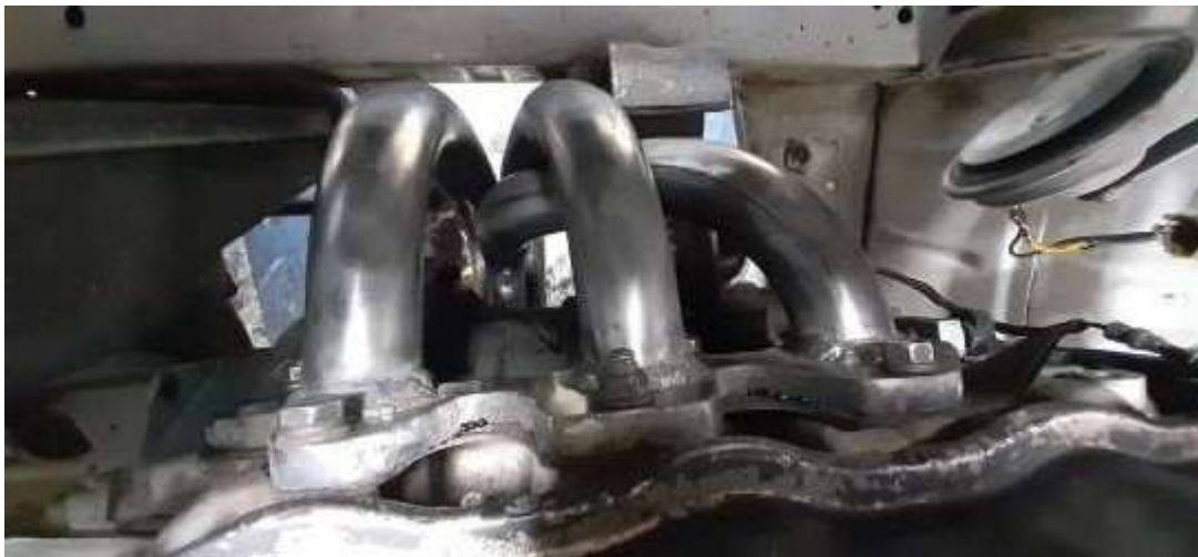
Figura 15-2: Header montado en el motor del vehículo de pruebas
