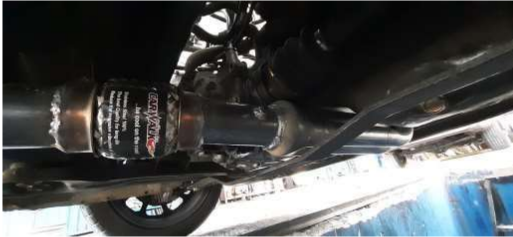
Figura 16-2: Tubería nueva para el sistema de escape del motor de prueba
