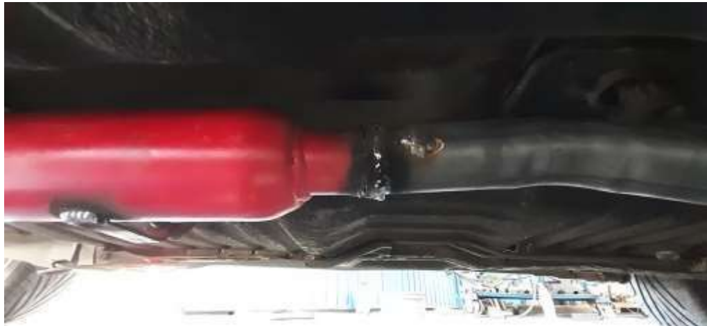
Figura 17-2: Resonador o bala, instalado en el sistema de escape
