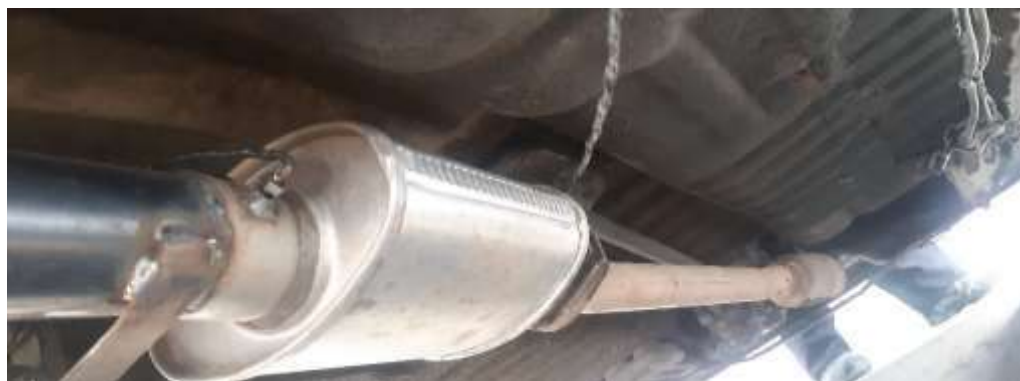
Figura 21-2: Termocupla colocada después del catalizador.
