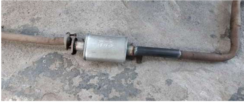
Figura 14-2: Catalizador de 3 vías, usado en el sistema de escape del vehículo de prueba.
