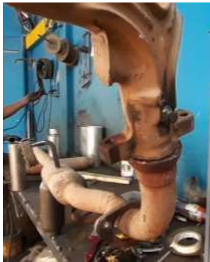
Figura 13-2: Adaptación para termocupla
