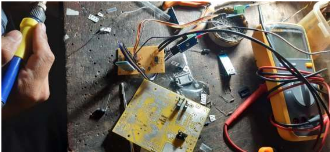
Figura 6-2: Elaboración de la placa para la recolección de datos
