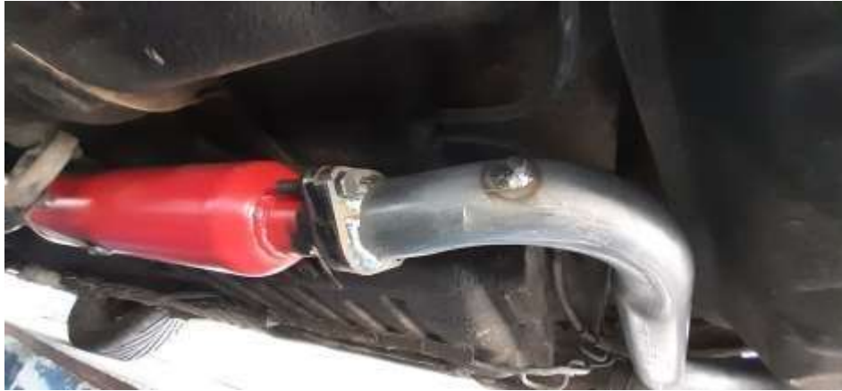
Figura 18-2: Acople usado para la termocupla en el sistema de escape ya modificado
