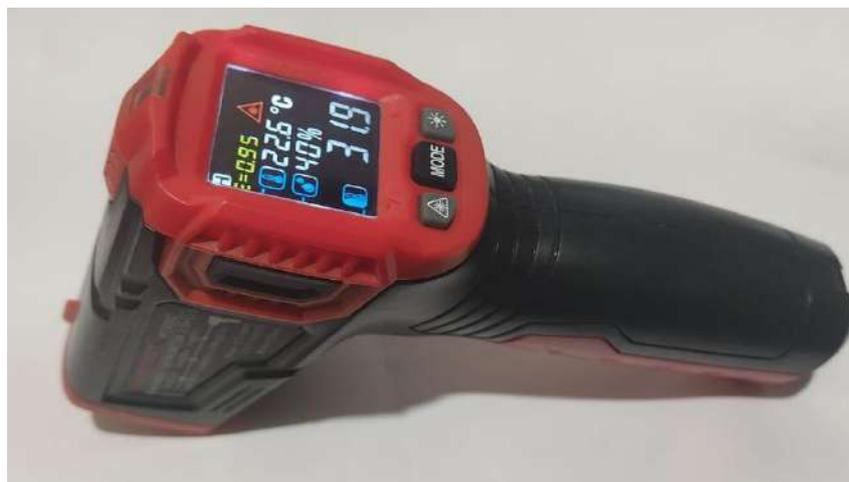
**Figura 24-2:** Termómetro infrarrojo de la marca habotest.
