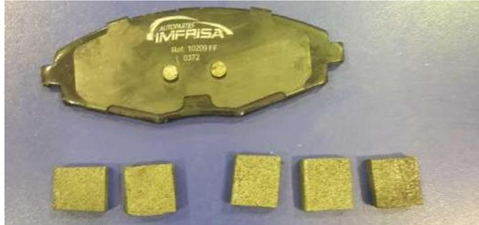
**Figura 11-2:** Probetas de la marca IMFRISA
