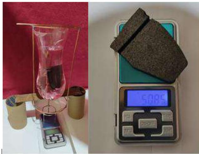
**Figura 3-2:** Medición del peso de un fragmento de pastilla
