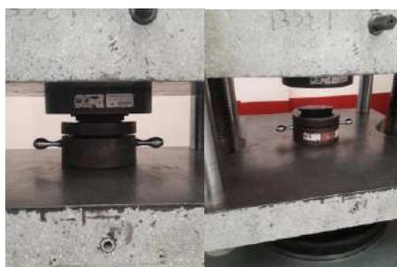
**Figura 13-2:** Aplicación de carga sobre las pastillas
