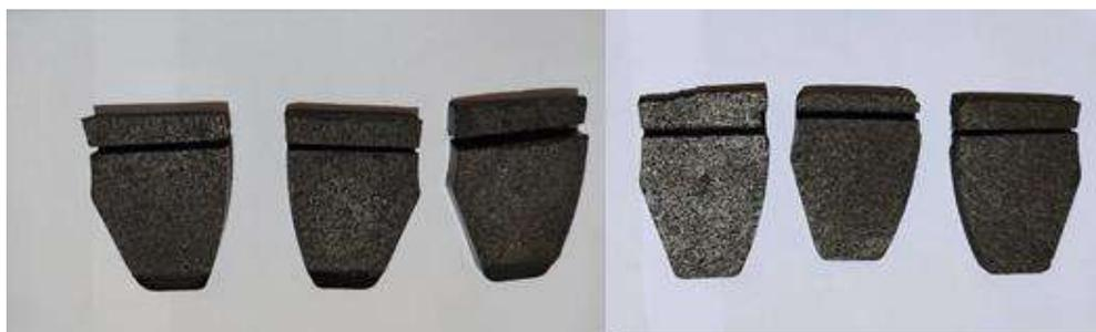
**Figura 4-2:** Corte de las pastillas en 50 g de las FMX y IMFRISA
