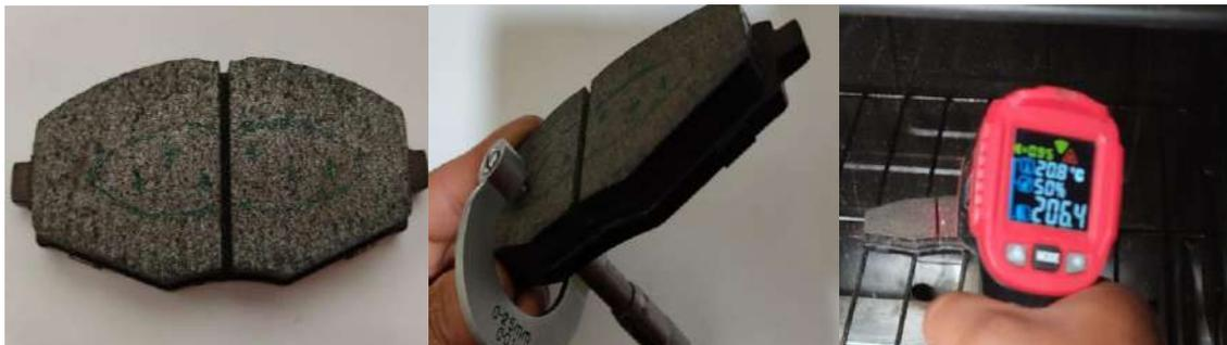
**Figura 7-2:** Marcado, medición y comprobación de temperatura; Pastillas IMFRISA
