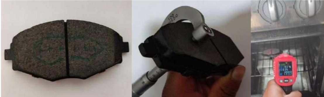
**Figura 5-2:** Marcado, medición y comprobación de temperatura; Pastilla FMX
