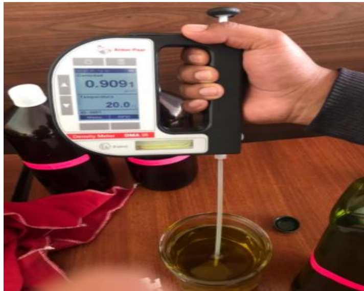
Figura 1-4. Medición de densidad
