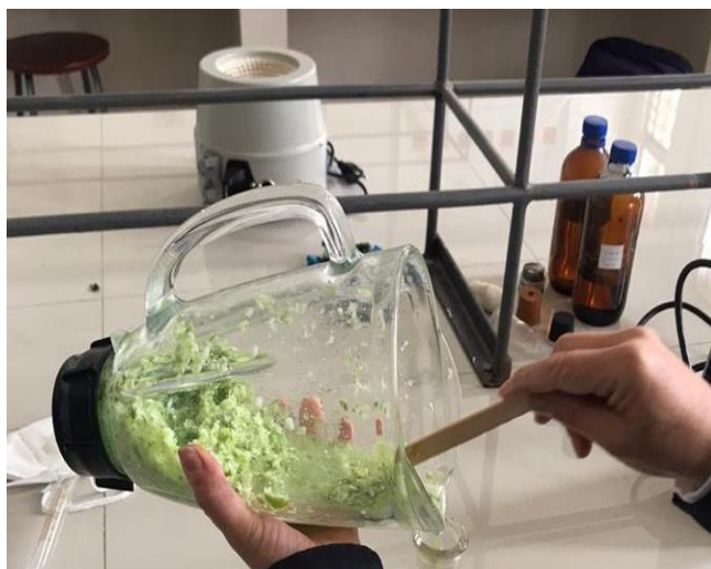
Figura 4-3. Trituración de la cascara de limón
