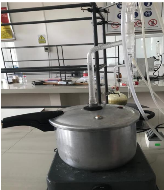
Figura 5-3. Destilación por arrastre de vapor
