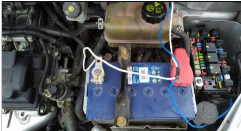
Conexión del optoacoplador a tierra y señal del relay del A/C (C.S.).
