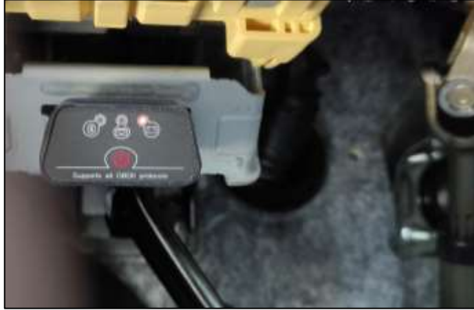
Conexión del Scanner en el puerto OBDII.
