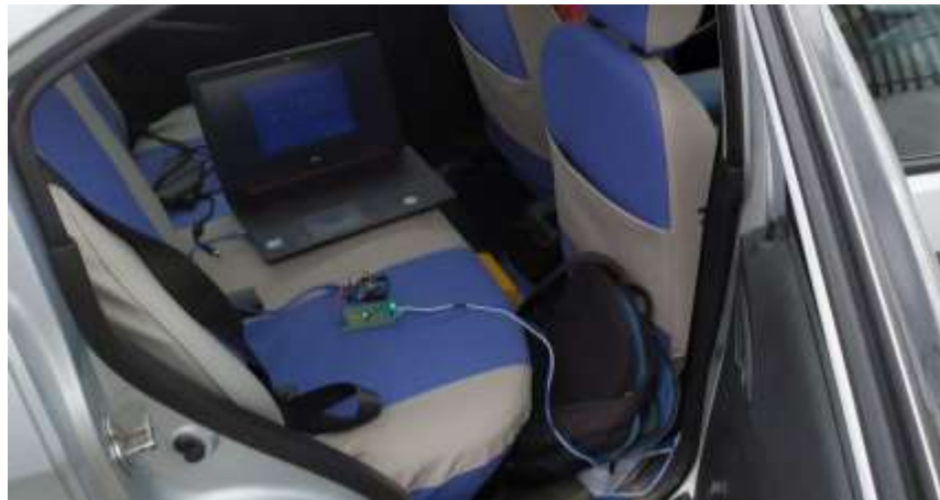
Optoacoplador conectado a la laptop.
