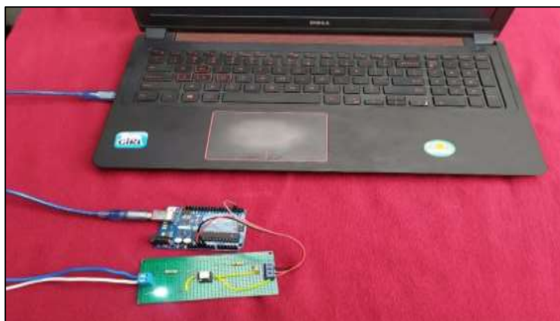
Figura 18-2: Sensor de activación de A/C.
