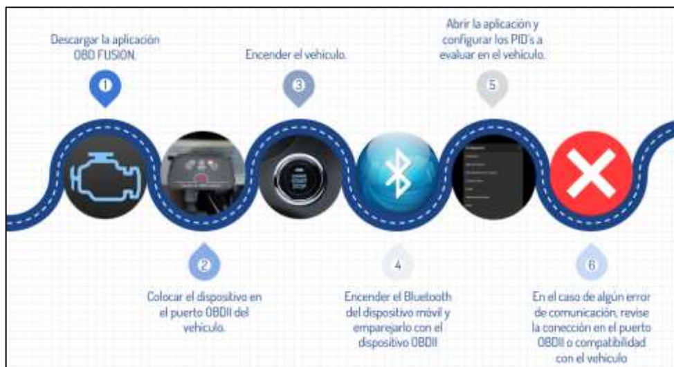
Figura 7-2: Proceso de Trabajo con el Scanner OBDII (ICAR Bluetooth).
