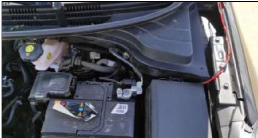
Conexión del optoacoplador a tierra y señal del relay del A/C (K.R.).
