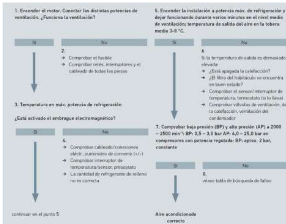
Figura 5-2: Revisión del aire acondicionado.
