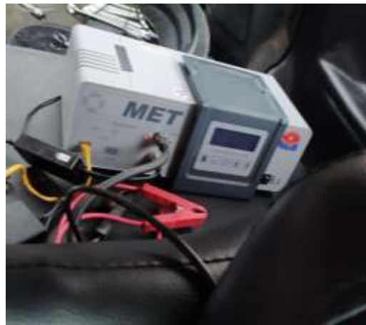
Figura 13-3: Analizador de gases.
