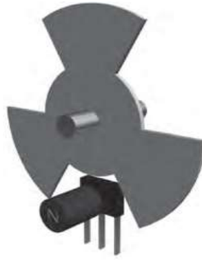
Figura 7-1: Encoder magnético con imán fijo.
