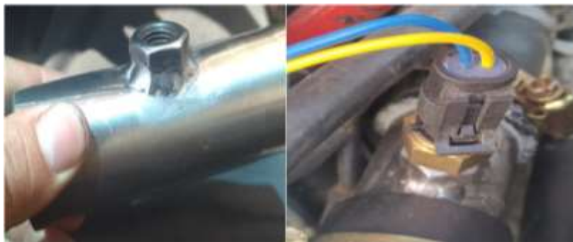
Figura 15-3: Toma de agua fabricada.
