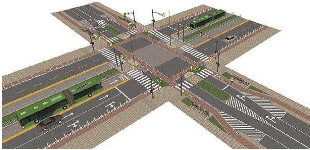
Figura 60-3: Semaforización de 4 fases - Terminal T3 Fuente: 053 CNTTTSV-DIR.2010 Realizado por: Peñafiel; A & Buñay, V. 2021
