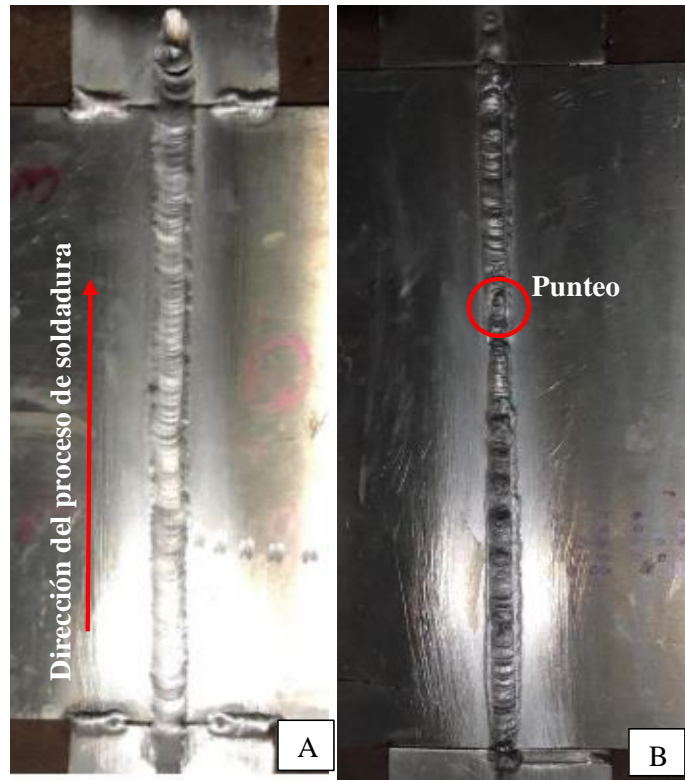
Figura 4-4. Cordón de soldadura (A) vista superior, (B) vista inferior
