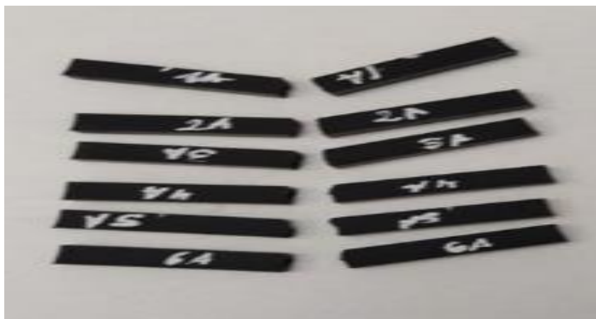
Figura 17-4. Probetas de PLA de material reciclado lote B después de realizar el impacto Charpy
