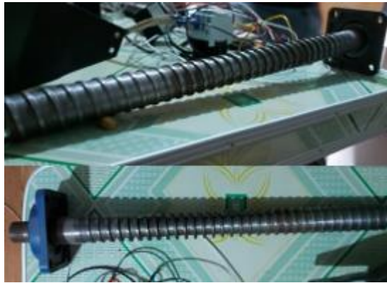
Figura 3-3. Tornillo de la extrusora maquinado
