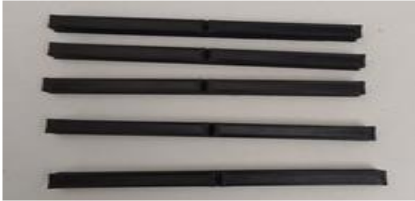
Figura 15-4. Probetas de PLA de material reciclado lote B antes de realizar el impacto Charpy
