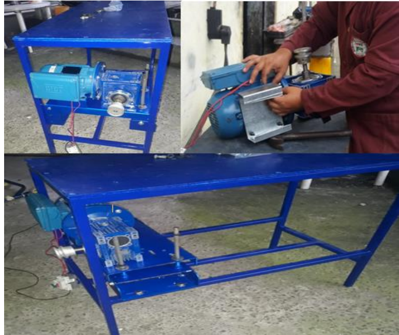
Figura 10-3. Ensamble del conjunto mesa, base del motor, y motoreductor.
