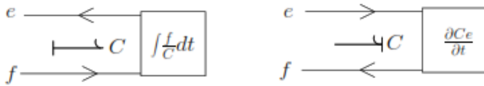
Figura 23-2. Causalidad integral (izquierda) y derivativa (derecha) para un elemento capacitivo.
