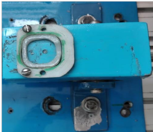
Figura 7-3: Base desmontable para aplicación de carga
