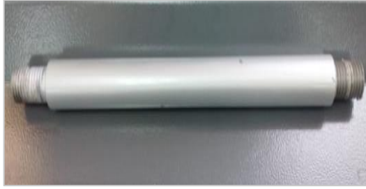
Figura 6-3: Vigas de soporte para sistema de aplicación de carga
