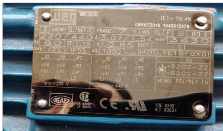
Figura 3-3: Placa característica del motor
