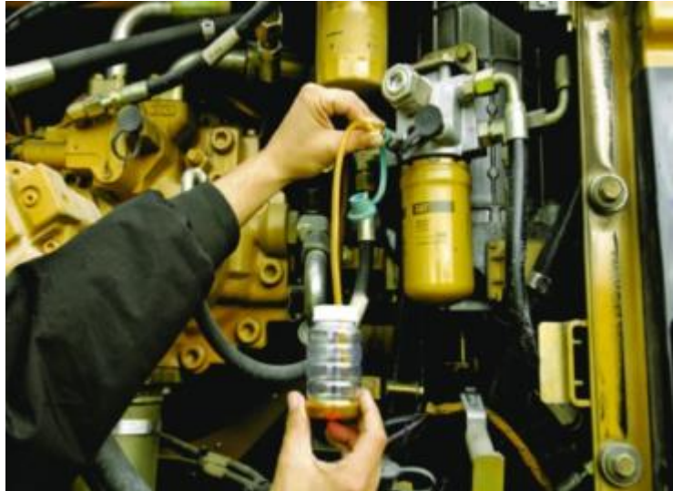
Figura 1-2: Extracción de muestra por medio de válvula
