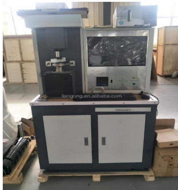
Figura 6-3: Tribómetro universal con módulos intercambiables
