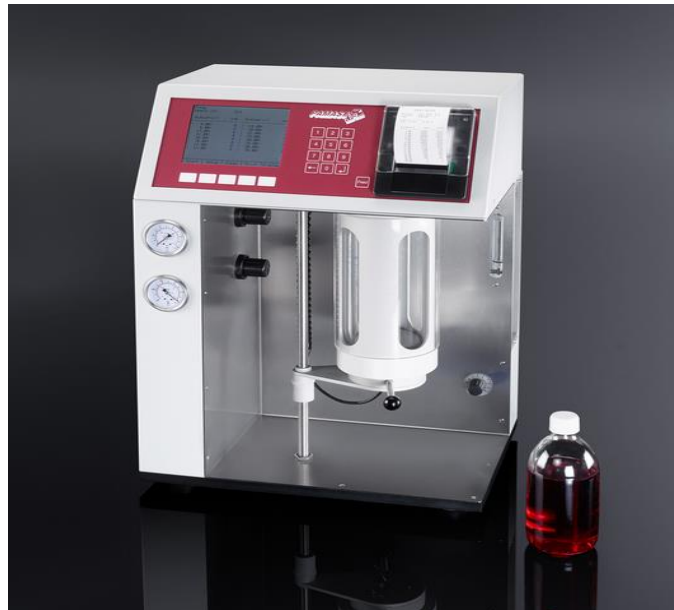
Figura 5-3: Analizador de aceites para partículas Pamas SBSS
