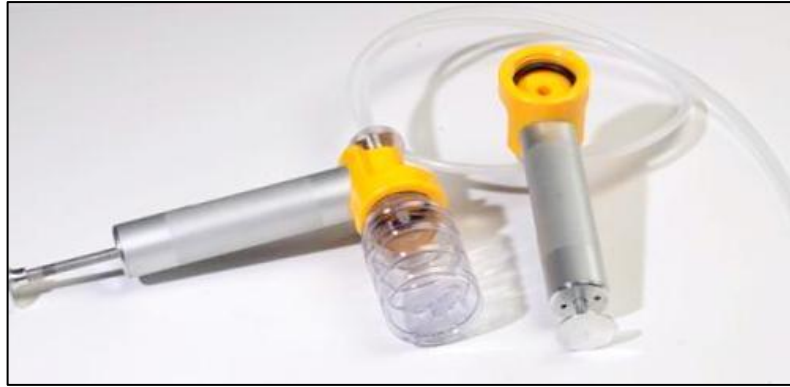
Figura 2-2: Bomba de vacío para muestra de aceites lubricantes Fuente: (Vimaroni [sin fecha])
