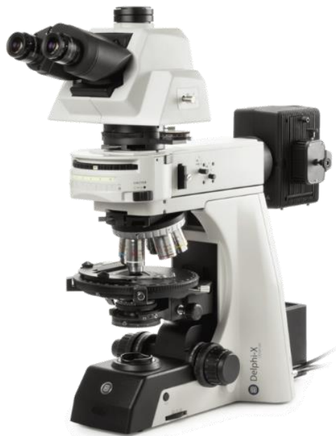
Figura 10-3: Microscopio metalográfico Delphi
