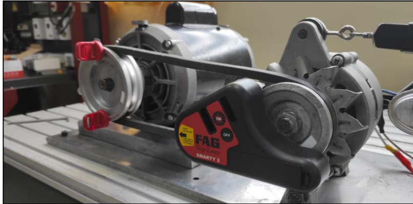
Figura 16-2: Alineación de poleas con el equipo FAG SMARTY 2.
