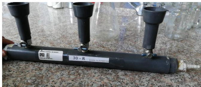
Figura 18-2: Rampa de filtración
