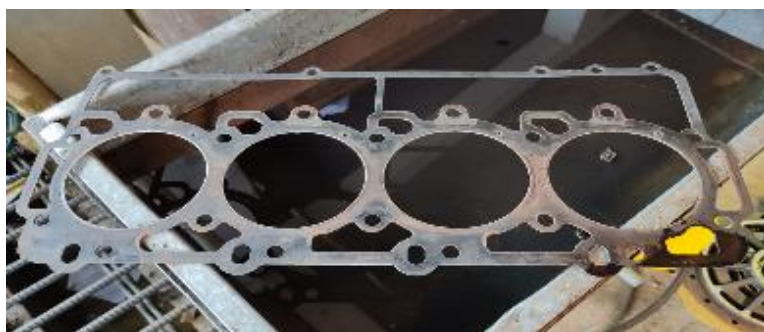
Figura 1-4: Sustitución del empaque de la culata del motor de combustión
