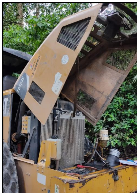
Figura 2-3: Motor de combustión del rodillo compactador
