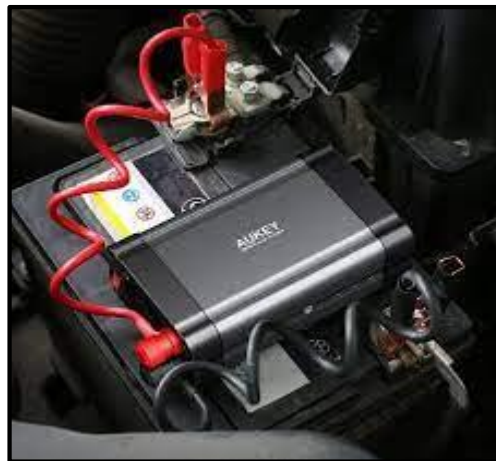
Figura 16-3: Batería de 12 V con inversor
