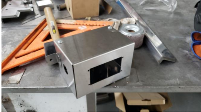
Figura 56-3: Caja contenedora construida en acero inoxidable de 1 mm de espesor Realizado por: Mosquera, Juan, 2021.
