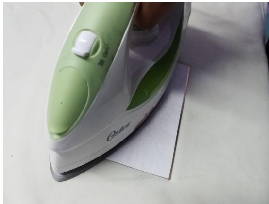
Figura 51-3: Transferencia del diseño a la placa.
