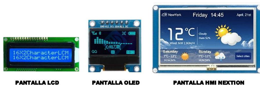
Figura 14-3: Dispositivos para visualización de la información
