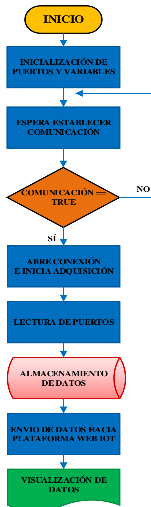
Gráfico 4-3: Diagrama de flujo del dispositivo de monitoreo
