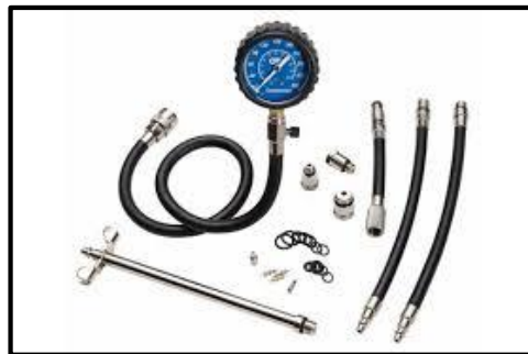
Figura 3-2: El compresímetro y sus accesorios
