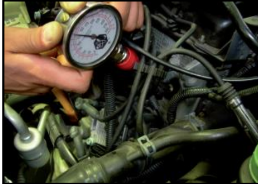
Figura 2-2: Comprobación de la compresión en un M.C.I
