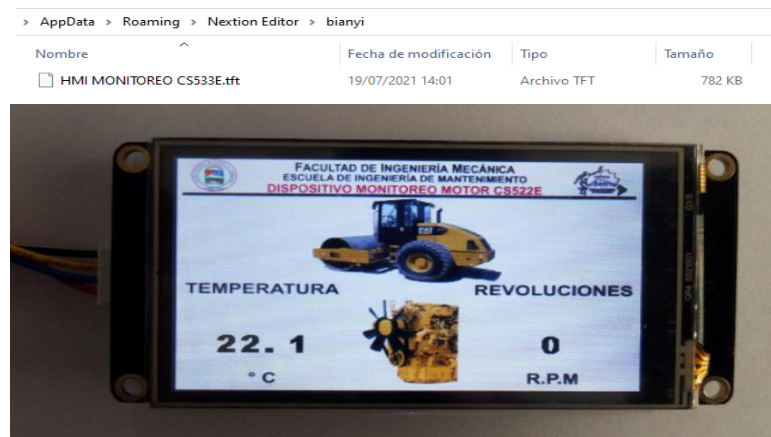
Figura 41-3: Implementación de la interfaz en la pantalla Nextion Realizado por: Mosquera, Juan, 2021.
