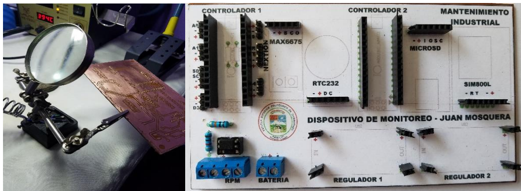
Figura 54-3: Adecuación de los componentes en la placa electrónica
