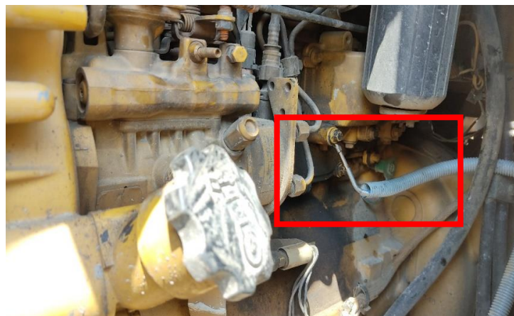
Figura 58-3: Ubicación del sensor de temperatura en el motor
