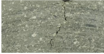
Figura 24-1: Grietas superficiales en pastillas de freno
