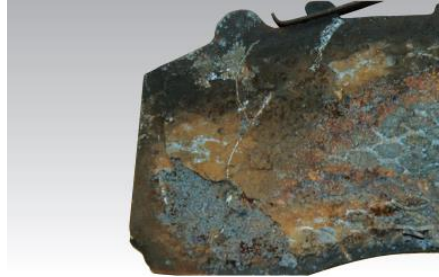
Figura 20-1: Alto grado de oxidación
