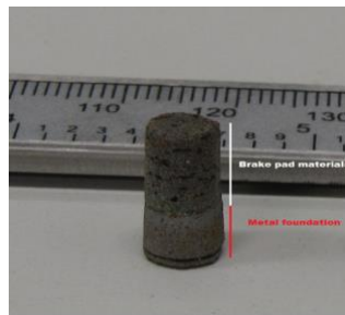
Figura 2-2: Muestra de pasador de pastilla de freno.
