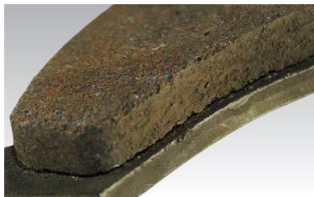
Figura 19-1: Desprendimiento de los bordes
