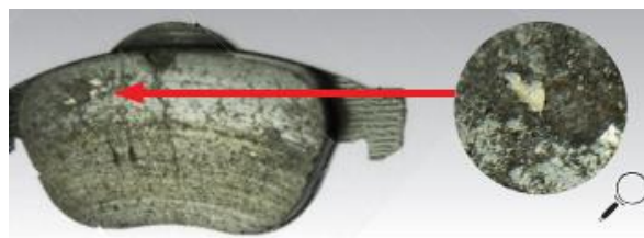
Figura 28-1: Formación de impurezas en la superficie del revestimiento
