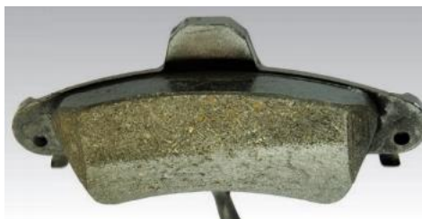
Figura 26-1: Pastilla con patrón de contacto insuficiente
