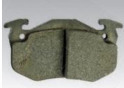
Figura 22-1: Pastilla dañada por influencias mecánicas
