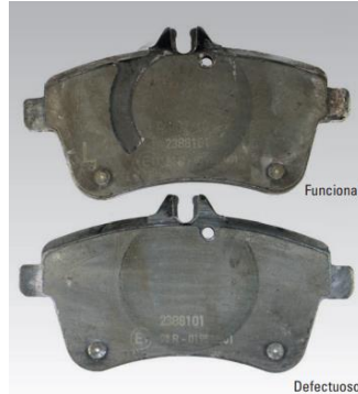
Figura 27-1: Marca visible en la placa de soporte de la pastilla
