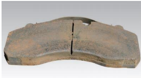
Figura 21-1: Pastilla dañada por destrucción térmica
