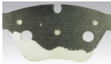
Figura 23-1: Pastilla dañada por producción defectuosa
