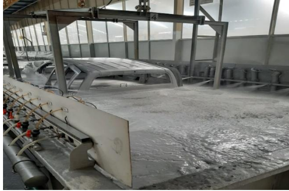
Figura 9-2. Proceso de electrodeposición de la carrocería
