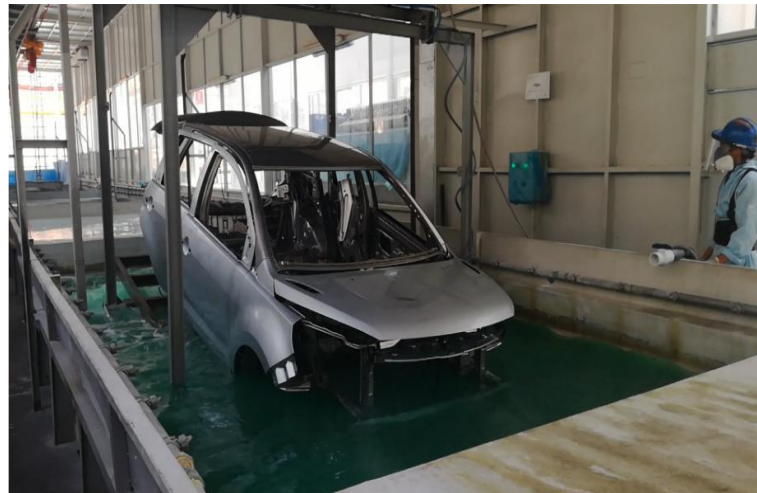
Figura 8-2. Proceso de Pasivado de fosfato
