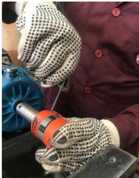
Figura 41-3: Colocación del eje y acople
