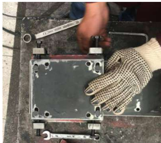
Figura 35-9: Dimensionamiento de los soportes para desalineación
