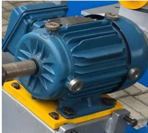
Figura 2-3: Motor trifásico de 1/2 HP
