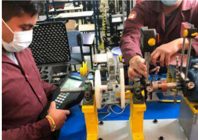
Figura 6-4: Alineación del módulo de simulación
