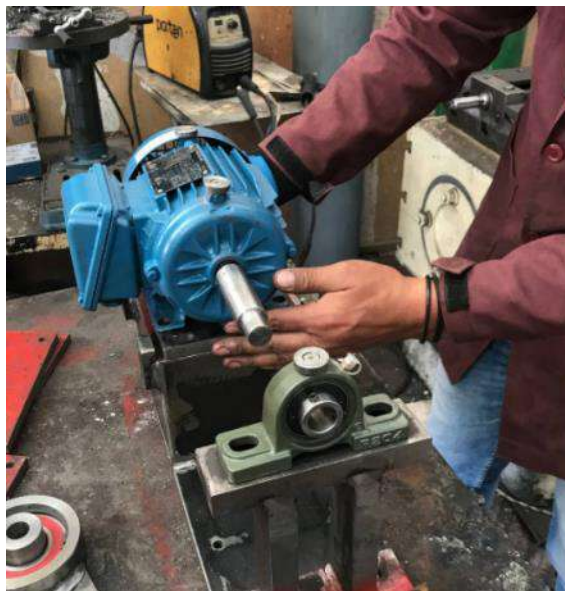
Figura 39-13: Colocación del motor eléctrico
