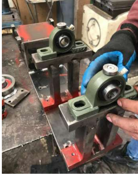
Figura 34-8: Colocación de chumaceras
