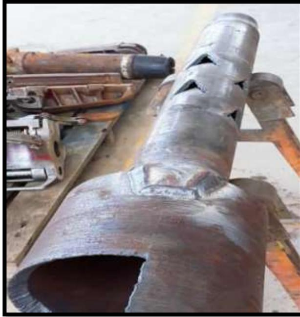
**Figura 1-3.** Fabricación de guía 8 1/8 para pesca de tubería de 2 3/8
