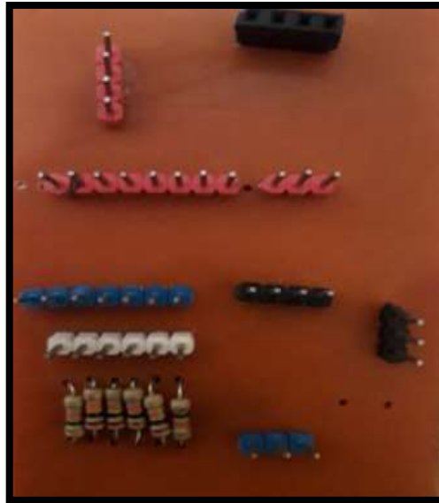
Figura 5-4: Conexión de los espadines en la placa
