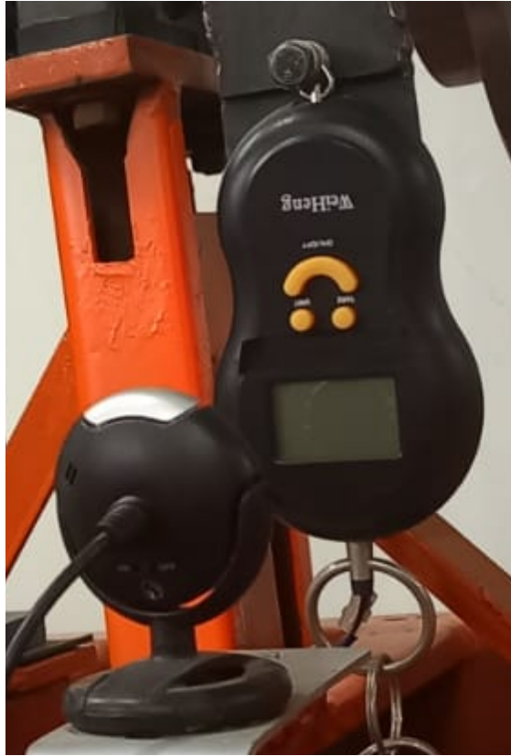
Figura 20-3: Dinamómetro digital y cámara (sistema anterior)
