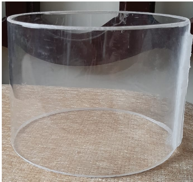
Figura 15-3: Tubería de acrílico después del mantenimiento
