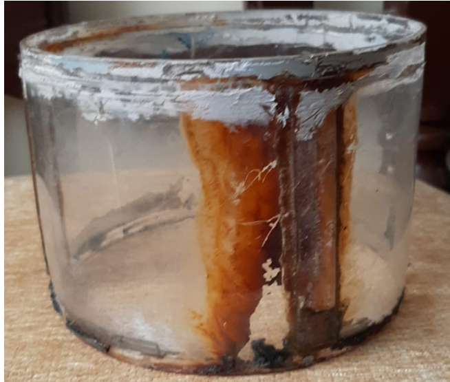
Figura 14-3: Tubería de acrílico antes del mantenimiento
