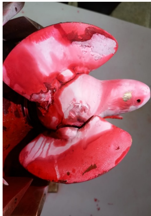
Figura 11-3: Ensayos con líquidos penetrantes
