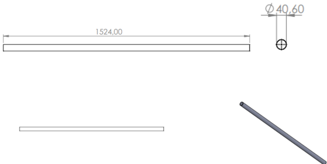
Figura 8-2: Ánodo de Mg, tipo varilla (núcleo de alambre)
