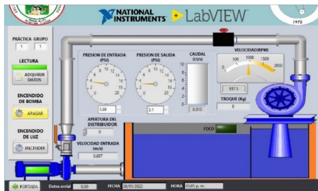
Figura 1-4: Ejecución del programa LabVIEW y arduino
