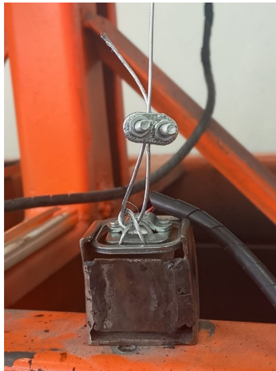
Figura 21-3: Sensor celda de carga (sistema implementado)
