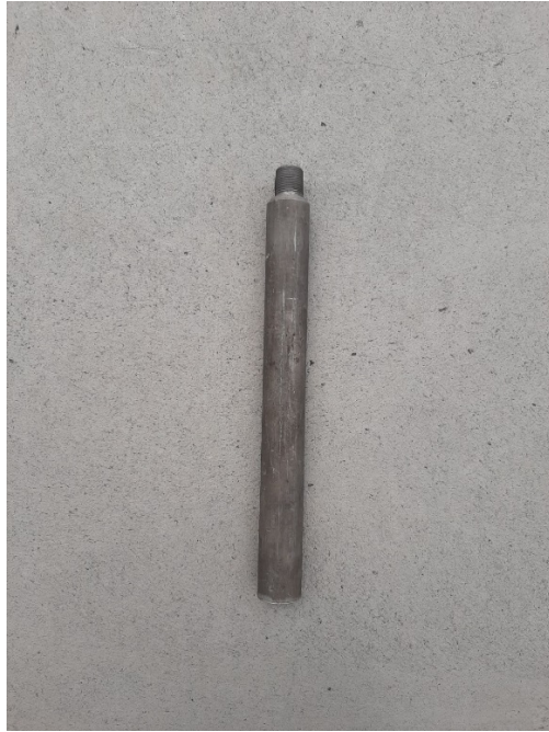
Figura 31-3: Ánodo de Mg clase 2 tipo MVA-2.23-AAF
