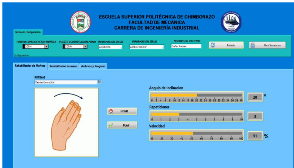
Figura 59-2: Rehabilitación desviación cubital
