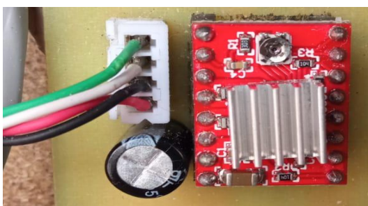
Figura 7-1: Controlador de motores
