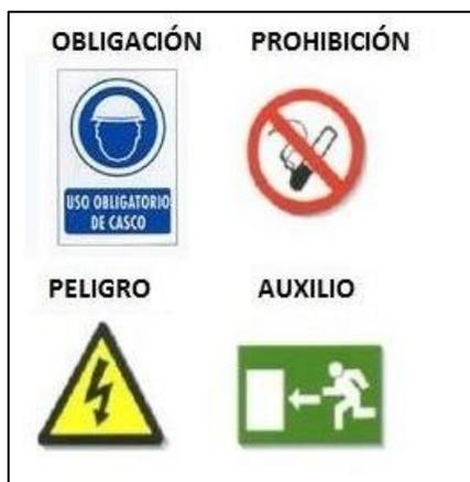
**Figura 1-2:** Tipos de señalización
