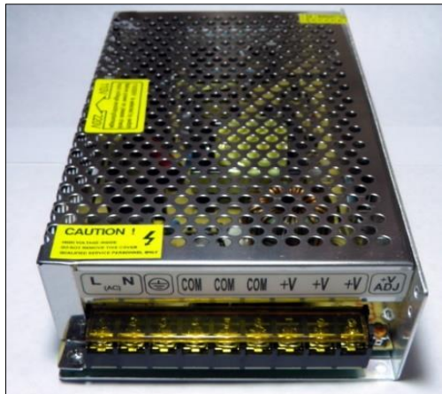
Figura 17-3: Fuente conmutada 12v-20 A
