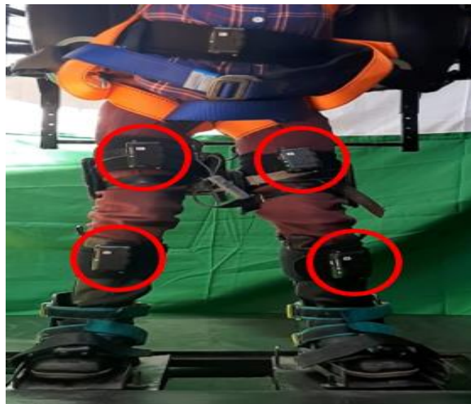
Figura 53-3: Posicionamiento de sensores inerciales - Rodilla
