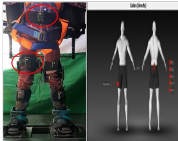
Figura 51-3: Posicionamiento de sensores inerciales -Cadera
