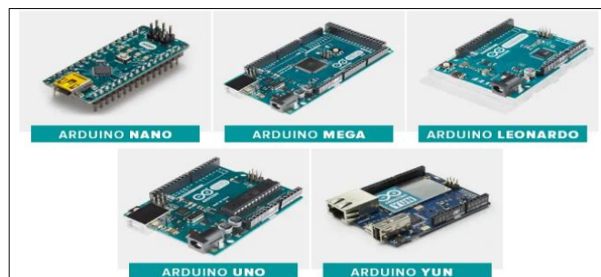
Figura 14-2: Tipos de placa arduino
