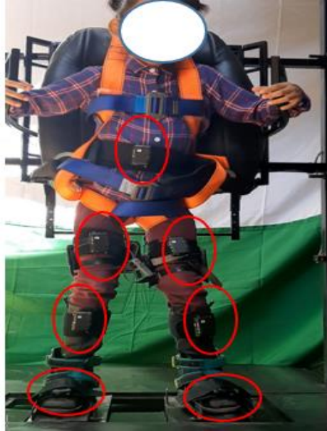
Figura 48-3: Posicionamiento de sensores inerciales
