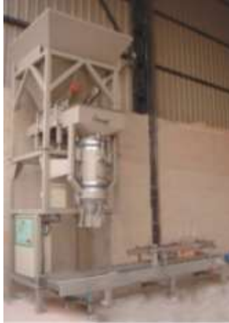
Figura 15-1: Ensacadora saco boca abierta
