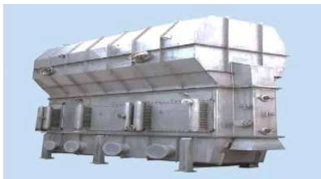
Figura 13-1: Secador de Lecho Fluidizado con Calefacción Interna.
