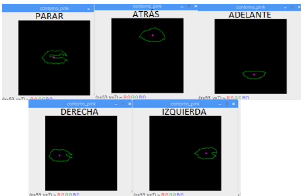
Figura 27-2. Posición de Labios para movimientos del prototipo Realizado por: Insuasti, D.,2020
