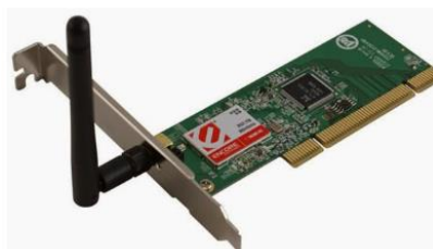
Figura 25-1. Controlador de Red Fuente: Blog Controladores, 2019
