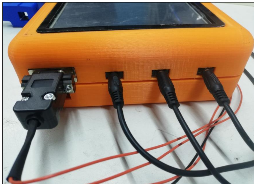
Figura 5-3: Terminales de conexión para sensores de voltaje y corriente
