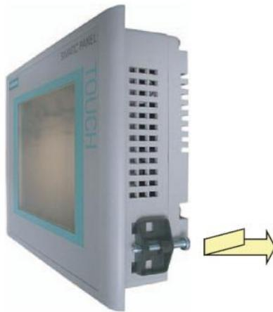
**Figura 3.7:** Colocación de una mordaza de plástico
