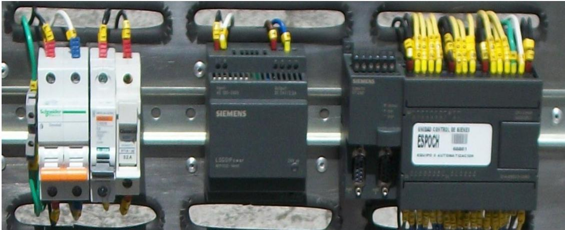
**Figura 4.22:** Ubicación de los dispositivos en el Riel DIN.
