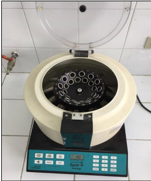
Figura 7. Colocar en la centrifuga a 3000 rpm por 4 minutos, hasta obtener una solución homogénea.
