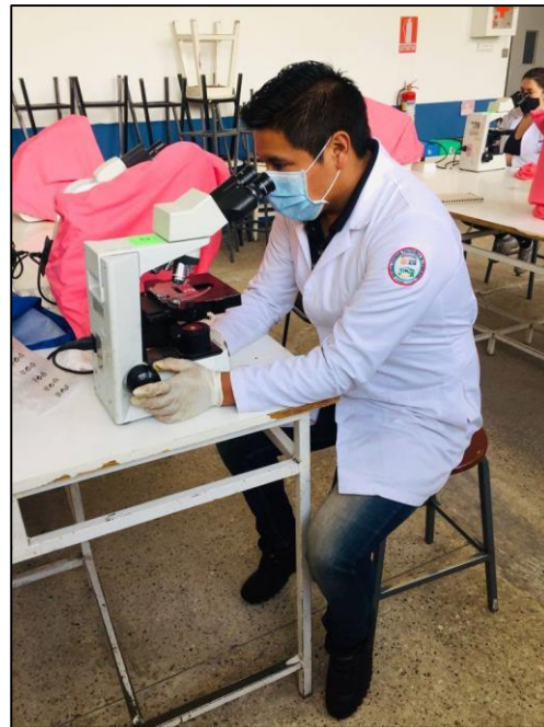
Figura 14. Observar los granos de polen de cada una de las muestras de Miel en el Microscopio Óptico a 100 X.
