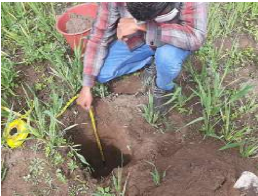
Imagen 15. Profundidad de la calicata (60 cm).
