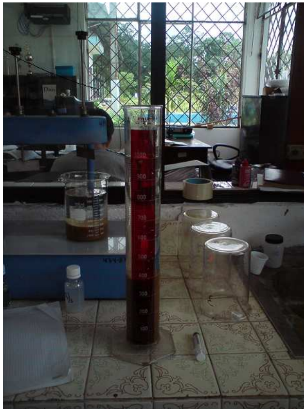
Fig. 2.2.3.2 – 1 Prueba de sedimentación de lodo
