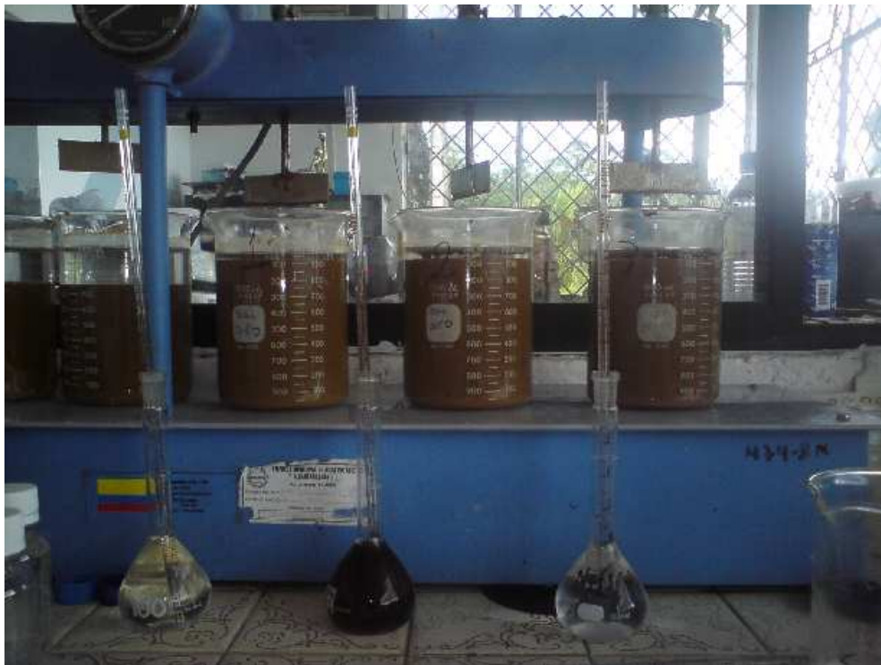
Fig. 2.2.3.1-1 Prueba de jarras con lodo de sedimentadores
